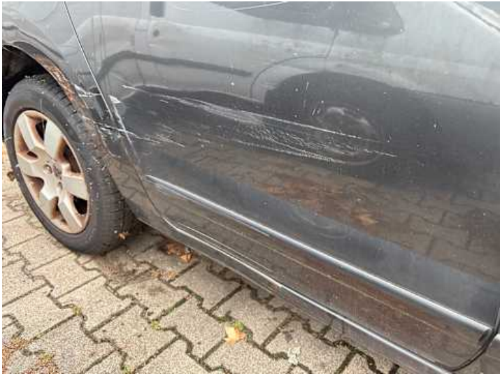
Türe hinten rechts (Verformung, Lackschaden)
