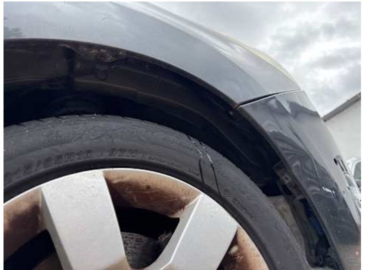
Kotflügel vorne rechts (Riss/Bruch)
