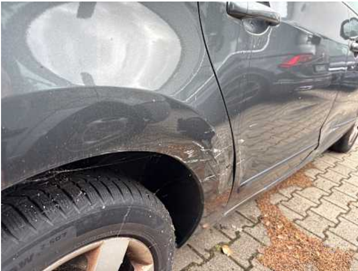
Seitenteil hinten rechts (Verformung, Lackschaden)
