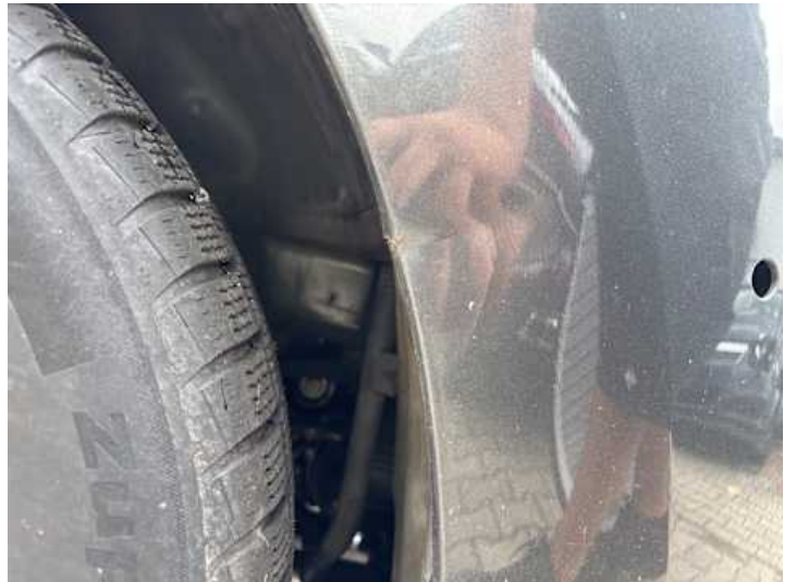
Stoßstange vorne (Spaltmaße ungenau, Riss/Bruch)
