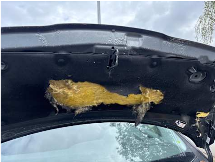
Motorhaube (Anderer Schaden): Dämmung
