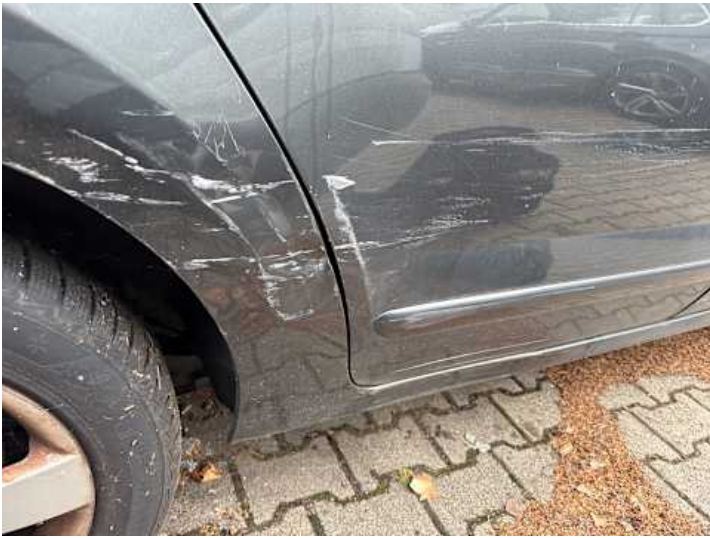
Türe hinten rechts (Verformung, Lackschaden)
