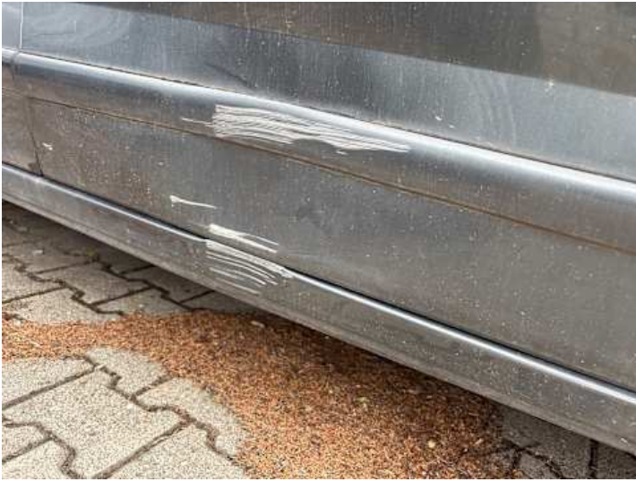
Schweller rechts (Verformung, Lackschaden)
