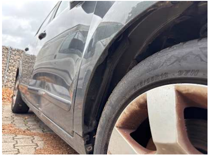
Kotflügel vorne rechts (Riss/Bruch)
