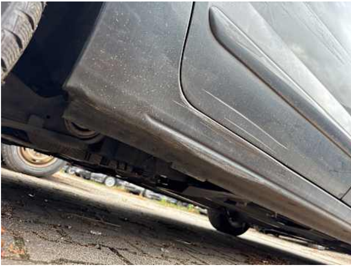
Schweller rechts (Verformung, Lackschaden)
