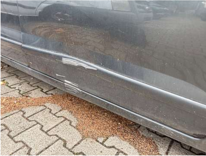
Beifahrtür (Lackschaden, Verformung)
