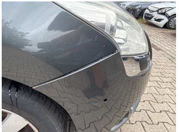
Stoßstange vorne (Spaltmaße ungenau, Riss/Bruch)
