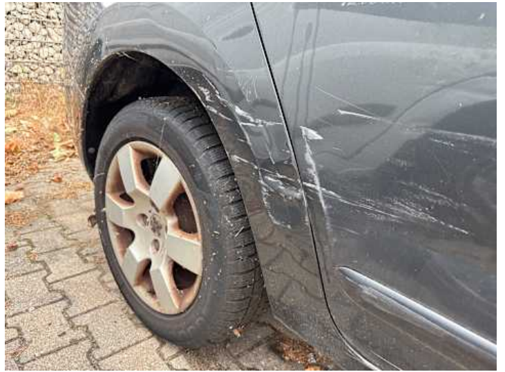
Seitenteil hinten rechts (Verformung, Lackschaden)
