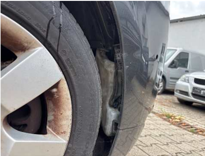
Kotflügel vorne rechts (Riss/Bruch)
