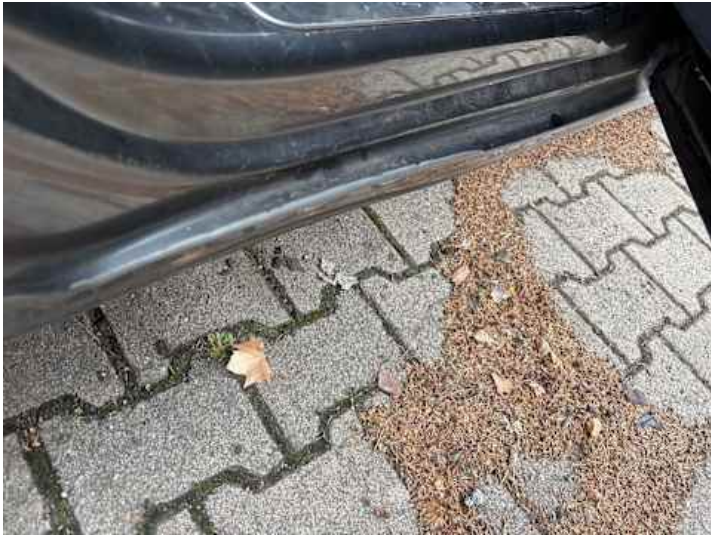
Schweller rechts (Verformung, Lackschaden)
