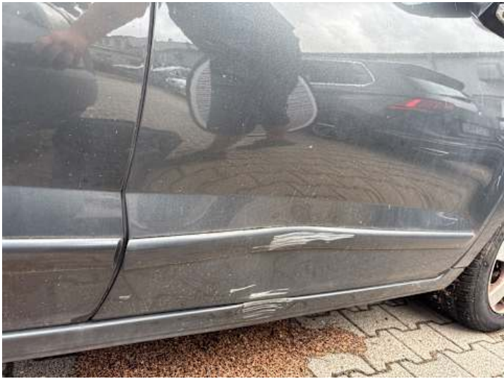
Beifahrtür (Lackschaden, Verformung)
