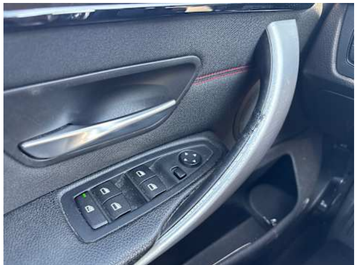
Innenraum (Diverse Schäden)
