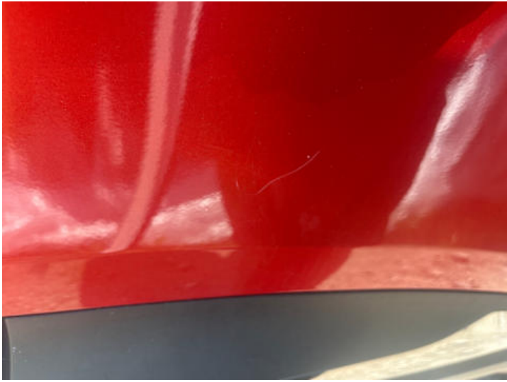
Türe hinten links (Kratzer, Lackschaden)
