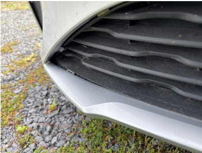
Stoßstange vorne (Riss/Bruch)
