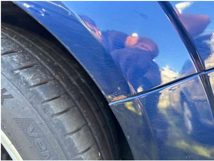
Kotflügel vorne rechts (Rost, Kratzer)
