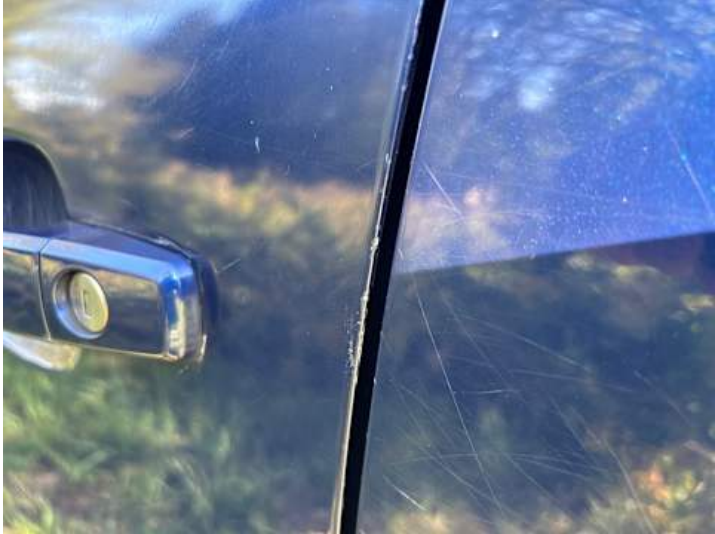
Fahrtür (Spaltmaße ungenau)
