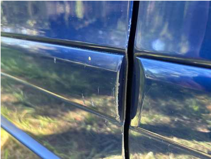
Fahrtür (Spaltmaße ungenau)
