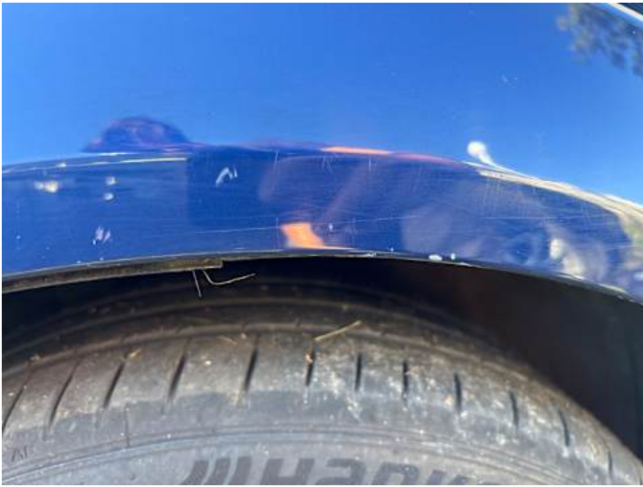
Kotflügel vorne rechts (Rost, Kratzer)
