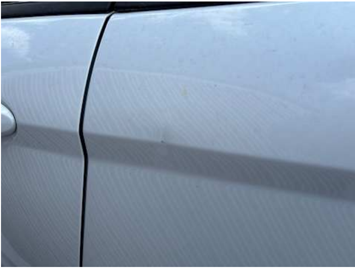
Seitenteil hinten links (Delle)
