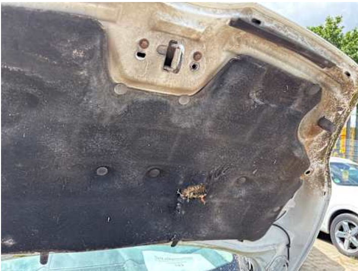
Motorhaube (Anderer Schaden): Dämmung beschädigt
