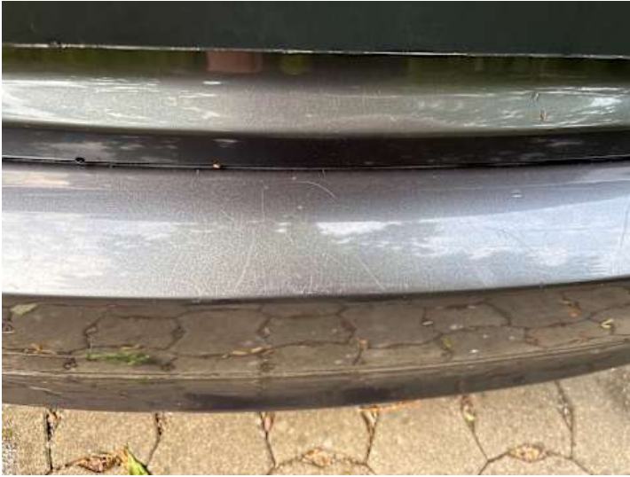
Stoßstange hinten (Lackschaden, Kratzer)
