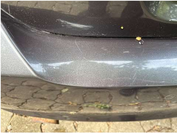
Stoßstange hinten (Lackschaden, Kratzer)
