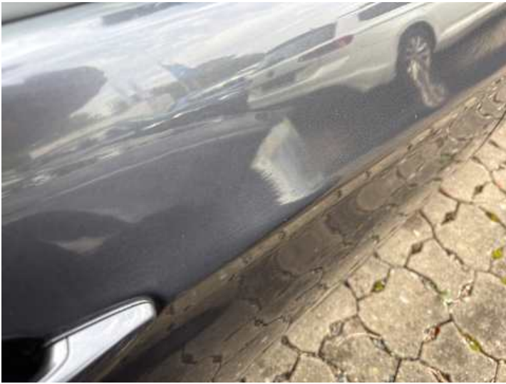
Türe hinten rechts (Unsachgemäß instand gesetzt, Verformung)
