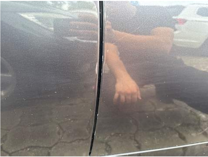
Beifahrertür (Lackschaden, Kratzer, Unsachgemäß instand gesetzt)
