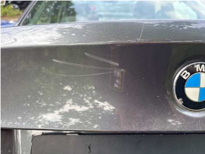
Heckklappe (Kratzer, Anderer Schaden): Dämpfer defekt
