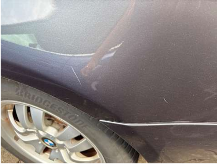
Seitenteil hinten links (Kratzer, Delle, Lackschaden)
