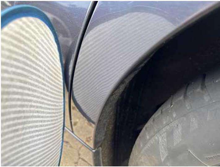
Seitenteil hinten links (Kratzer, Delle, Lackschaden)
