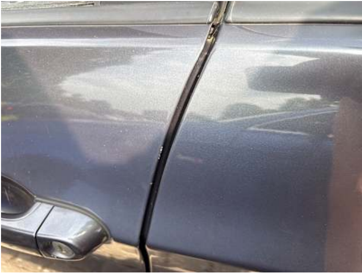
Fahrtür (Lackschaden, Kratzer, Delle)
