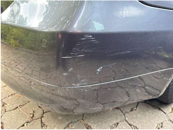
Stoßstange hinten (Lackschaden, Kratzer)
