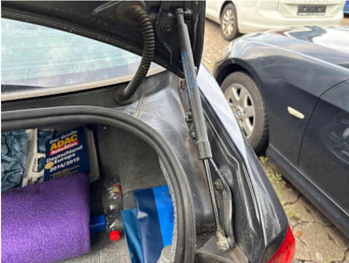
Heckklappe (Kratzer, Anderer Schaden): Dämpfer defekt
