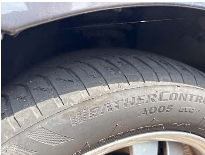
Rad (vehicle.damage-label.porous, Ungleichmäßig abgefahren)
