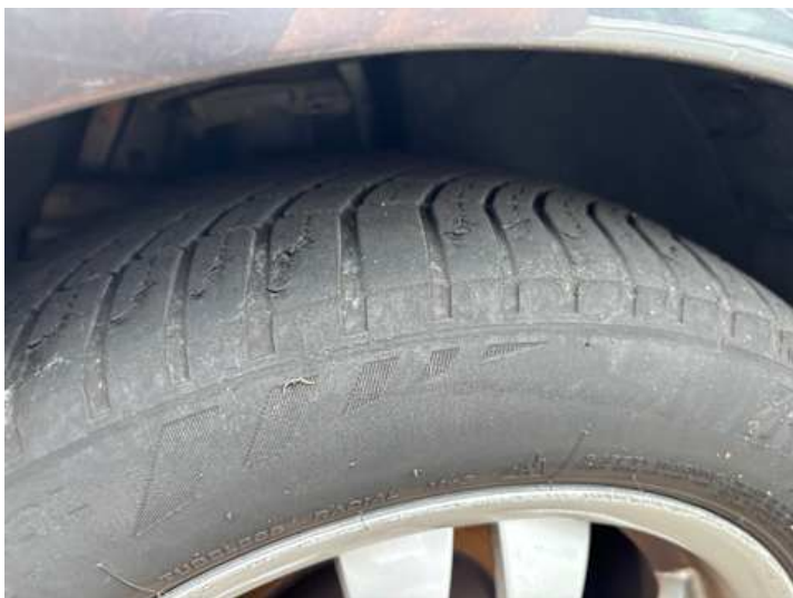
Rad (Ungleichmäßig abgefahren, vehicle.damage-label.porous, Kerben)
