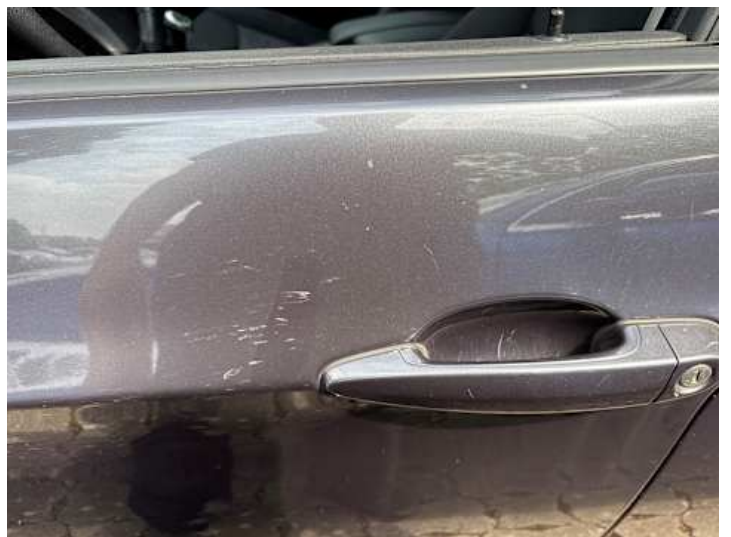
Fahrtür (Lackschaden, Kratzer, Delle)
