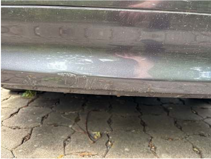
Stoßstange hinten (Lackschaden, Kratzer)
