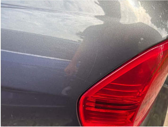
Seitenteil hinten links (Kratzer, Delle, Lackschaden)
