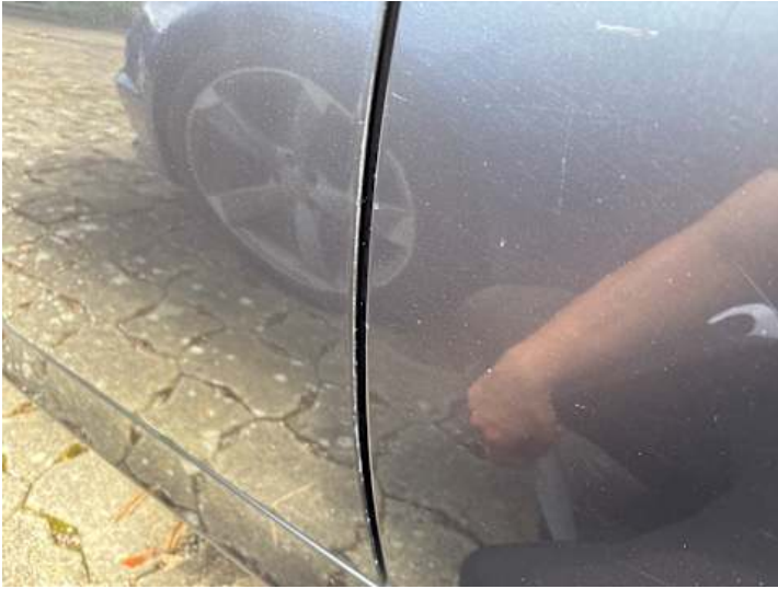
Fahrtür (Lackschaden, Kratzer, Delle)
