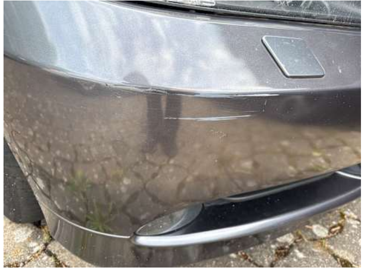
Stoßstange vorne (Lackschaden, Kratzer, Riss/Bruch, Verformung)
