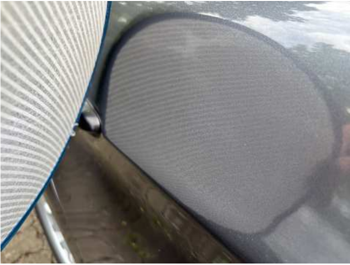
Türe hinten rechts (Unsachgemäß instand gesetzt, Verformung)
