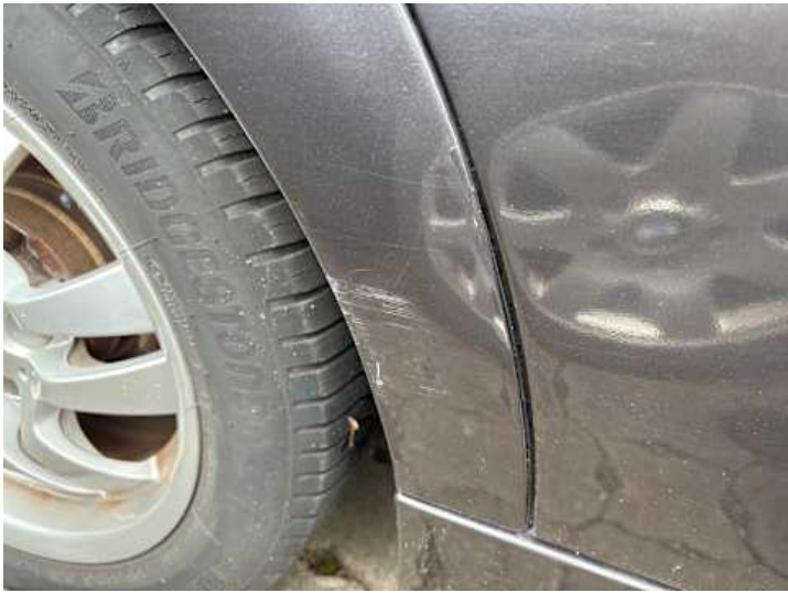
Seitenteil hinten rechts (Lackschaden, Kratzer)
