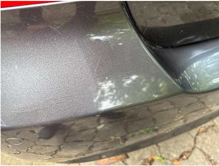
Stoßstange hinten (Lackschaden, Kratzer)
