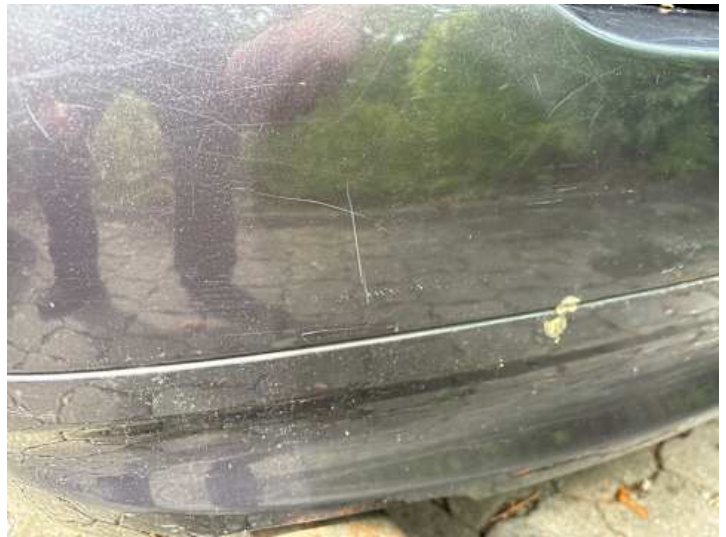
Stoßstange hinten (Lackschaden, Kratzer)
