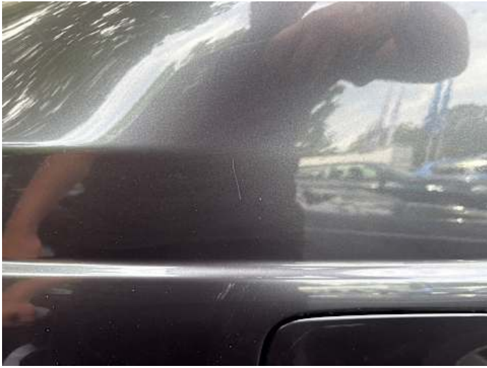
Seitenteil hinten rechts (Lackschaden, Kratzer)
