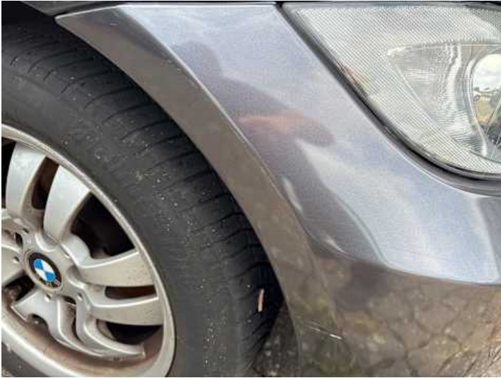
Stoßstange vorne (Lackschaden, Kratzer, Riss/Bruch, Verformung)
