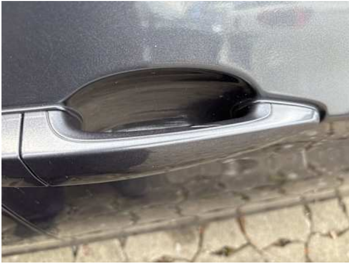
Beifahrtür (Lackschaden, Kratzer, Unsachgemäß instand gesetzt)
