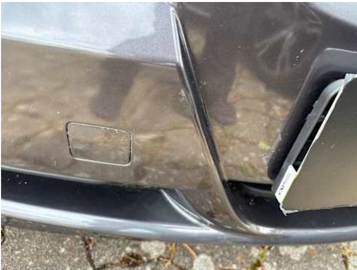
Stoßstange vorne (Lackschaden, Kratzer, Riss/Bruch, Verformung)
