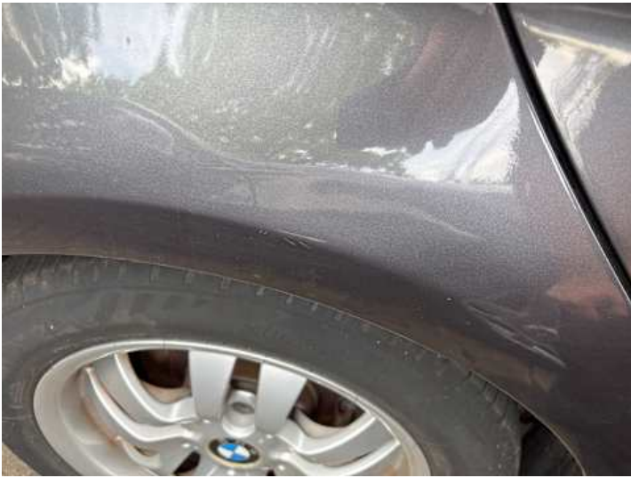
Seitenteil hinten rechts (Lackschaden, Kratzer)
