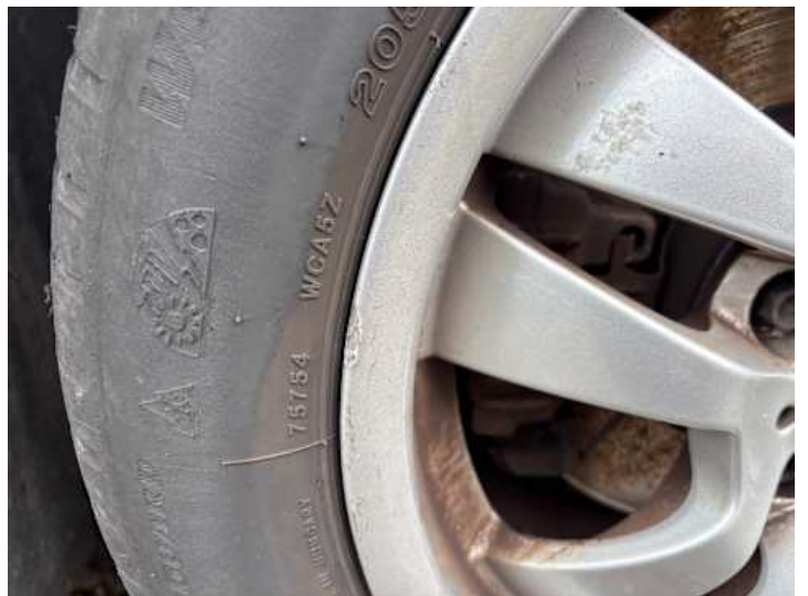
Rad (Ungleichmäßig abgefahren, vehicle.damage-label.porous, Kerben)
