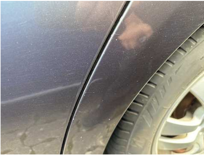
Seitenteil hinten links (Kratzer, Delle, Lackschaden)
