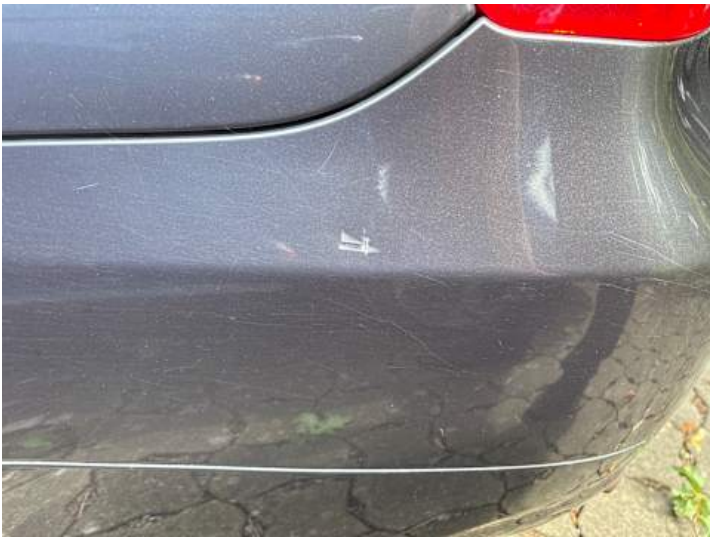
Stoßstange hinten (Lackschaden, Kratzer)
