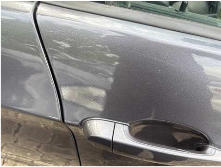
Beifahrertür (Lackschaden, Kratzer, Unsachgemäß instand gesetzt)
