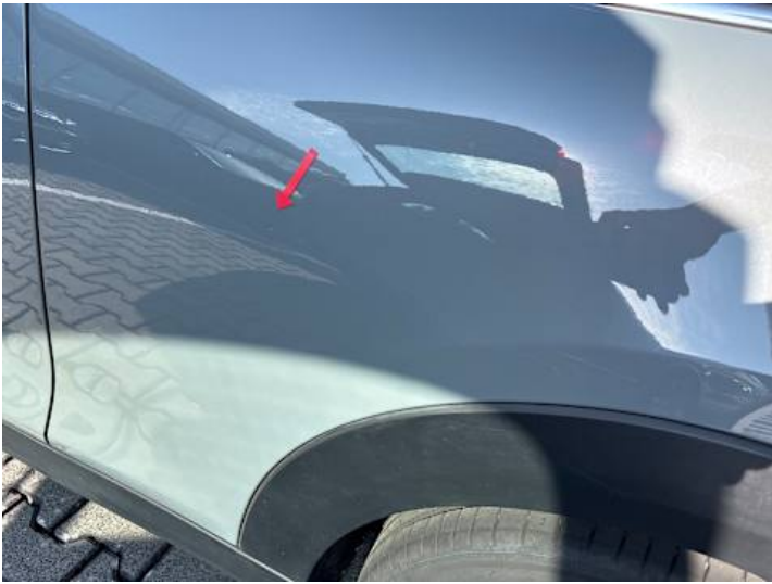
Seitenteil hinten links (Lackschaden, Delle)
