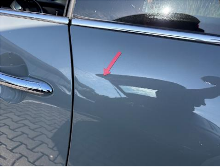
Seitenteil hinten links (Lackschaden, Kratzer)
