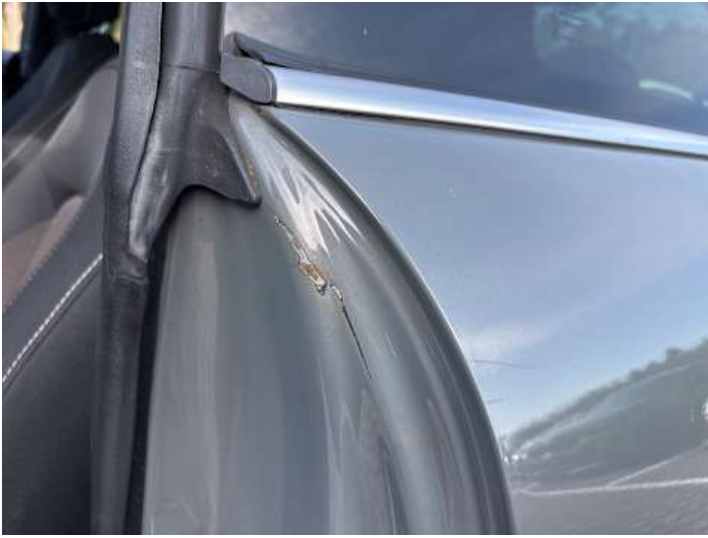
Seitenteil hinten links (Lackschaden, Rost)
