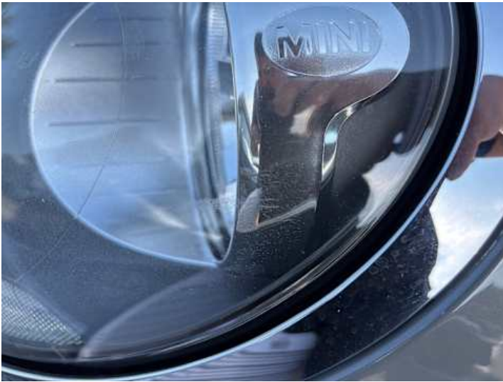
Scheinwerfer (links) (Anderer Schaden): Porös
