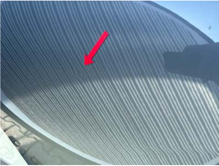
Seitenteil hinten links (Lackschaden, Delle)
