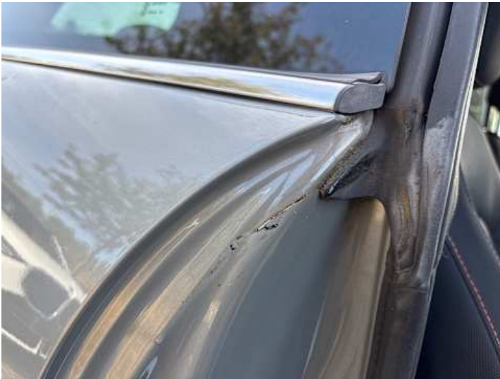
Seitenteil hinten rechts (Lackschaden, Rost)
