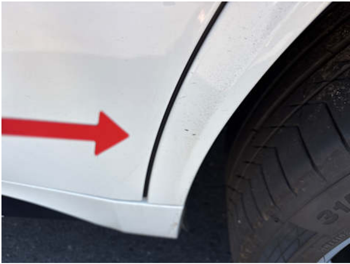
Seitenteil hinten links (Steinschlag)
