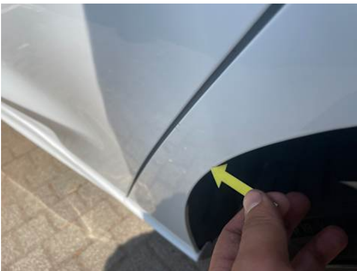
Seitenteil hinten links (Delle)
