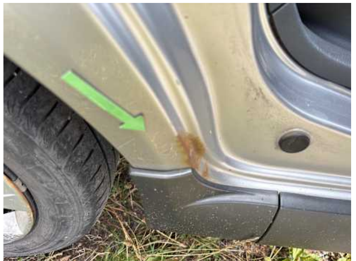
Seitenteil hinten rechts (Rost)
