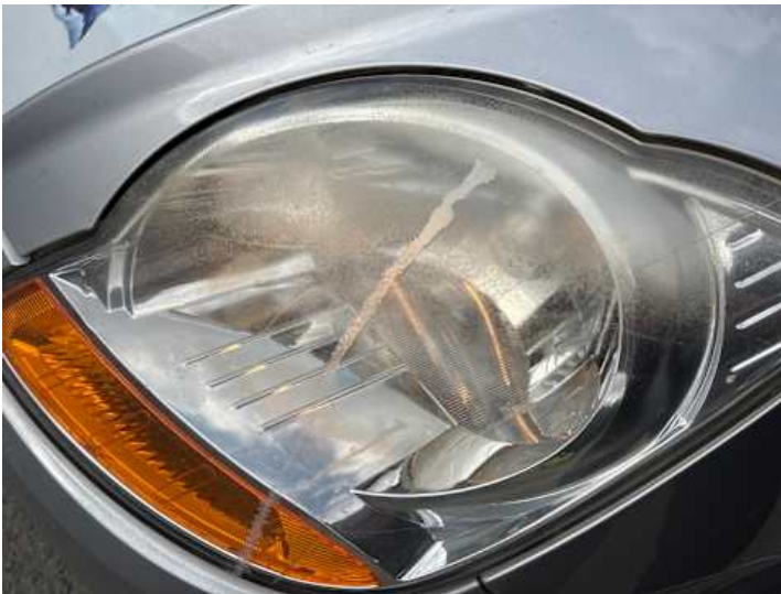
Scheinwerfer (links) (Blind, Anderer Schaden): Klarlack löst sich
