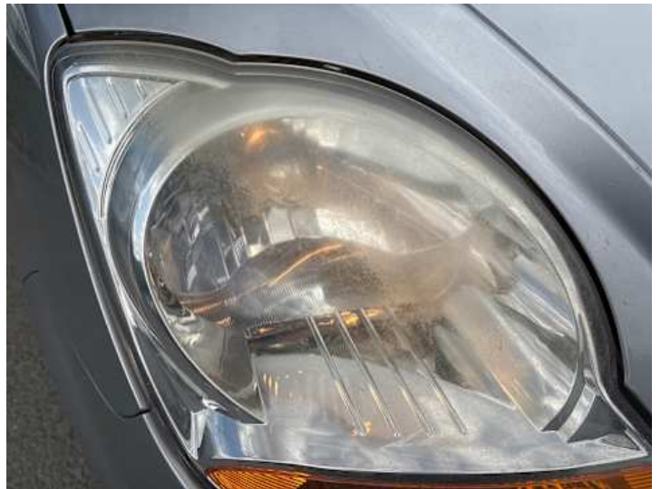
Scheinwerfer (rechts) (Blind, Anderer Schaden): Klarlack löst sich
