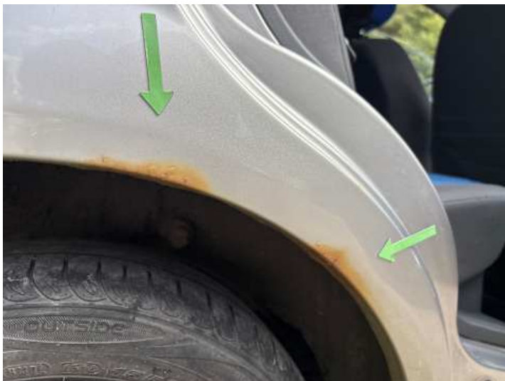
Seitenteil hinten rechts (Rost)
