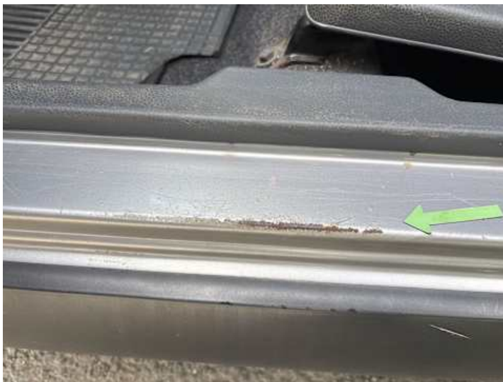
Schweller links (Rost, Lackschaden)
