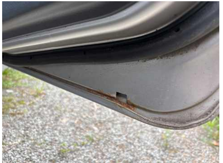
Türe hinten rechts (Rost)
