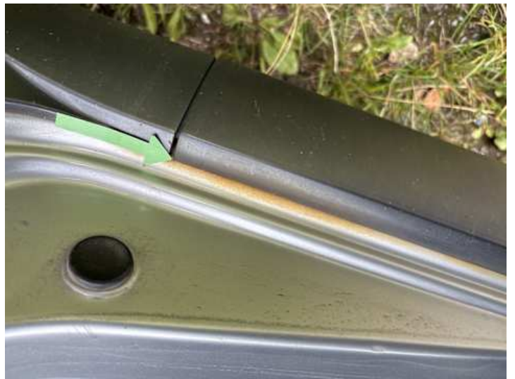
Schweller links (Rost)
