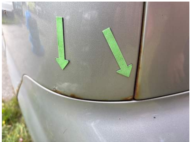
Seitenteil hinten links (Rost, Unsachgemäß instand gesetzt)
