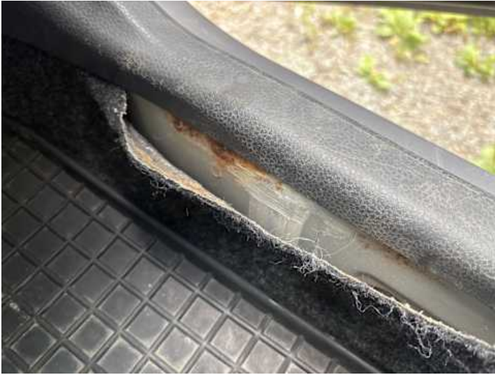
Innenraum (Anderer Schaden): Korrosion/Riss
