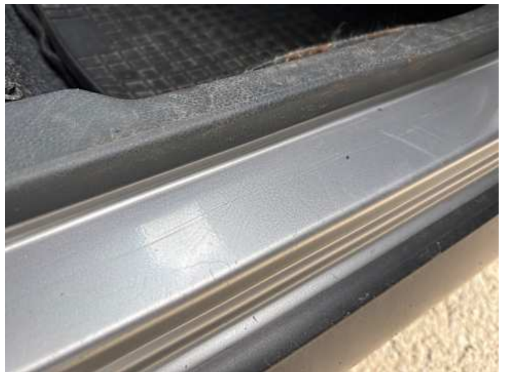
Schweller rechts (Kratzer, Rost)
