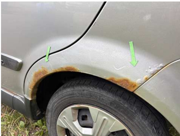
Seitenteil hinten links (Rost, Unsachgemäß instand gesetzt)
