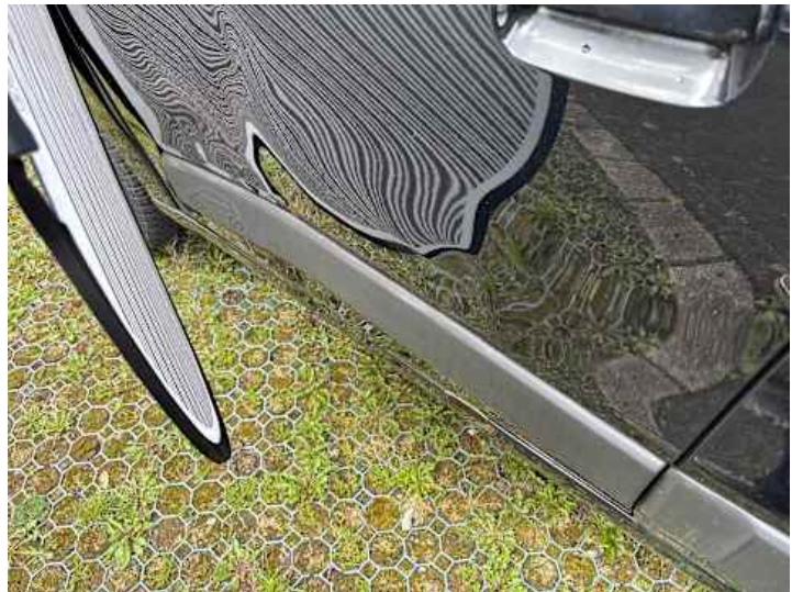
Fahrtür (Kratzer, Verformung)
