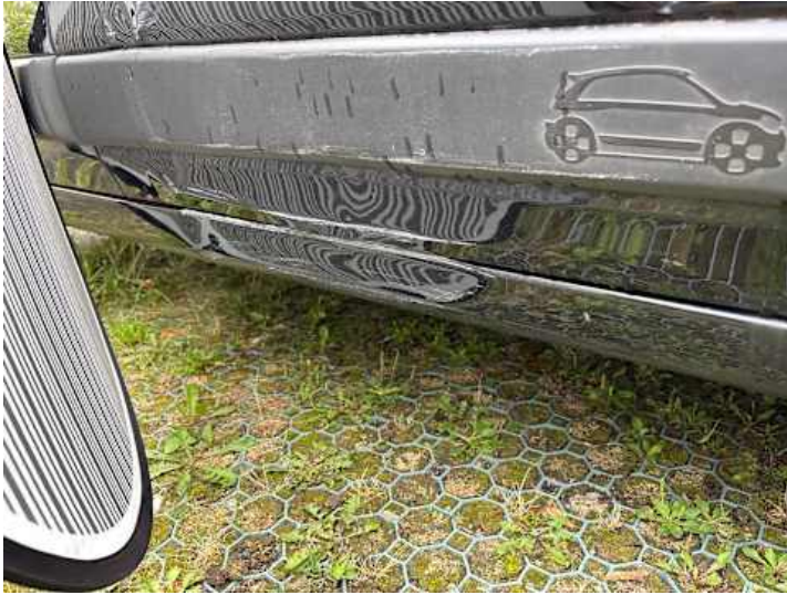
Schweller rechts (Kratzer, Verformung)
