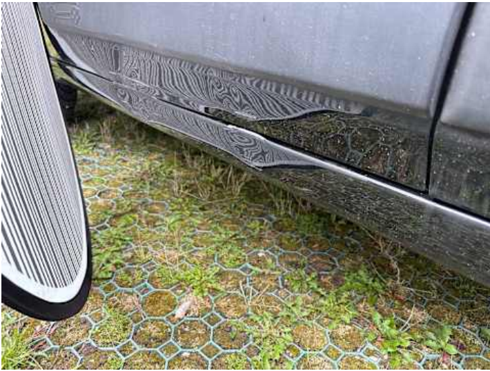
Schweller links (Kratzer, Verformung)
