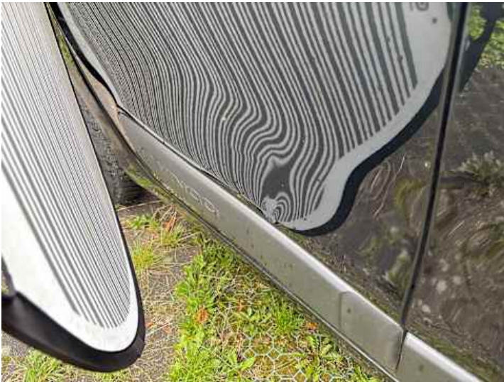
Türe hinten rechts (Kratzer, Verformung)
