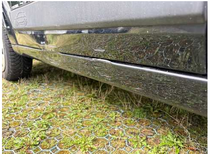
Schweller links (Kratzer, Verformung)
