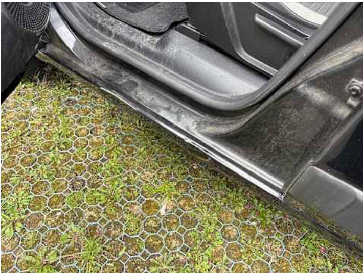
Schweller links (Kratzer, Verformung)
