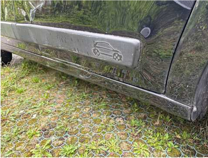
Schweller rechts (Kratzer, Verformung)
