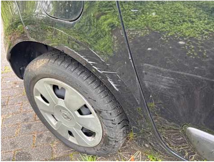
Seitenteil hinten rechts (Verformung, Kratzer)
