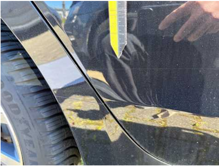
Türe hinten rechts (Lackschaden, Kratzer)
