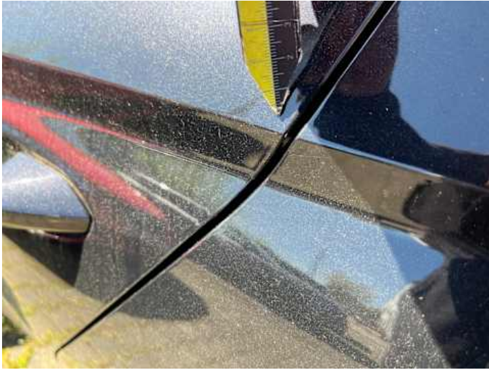
Türe hinten links (Lackschaden, Kratzer)
