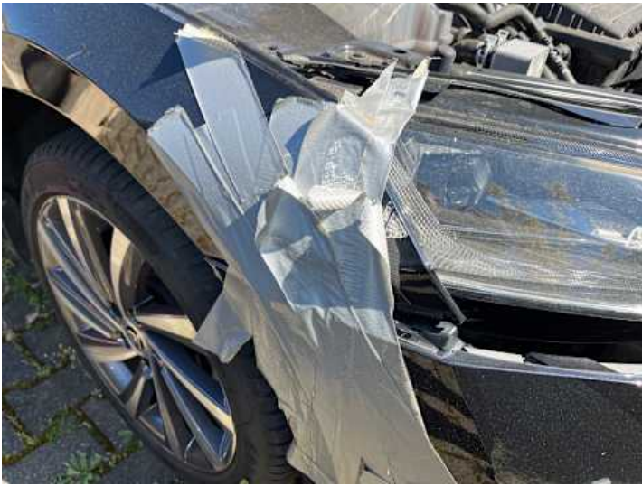
Kotflügel vorne rechts (Lackschaden, Kratzer, Verformung)
