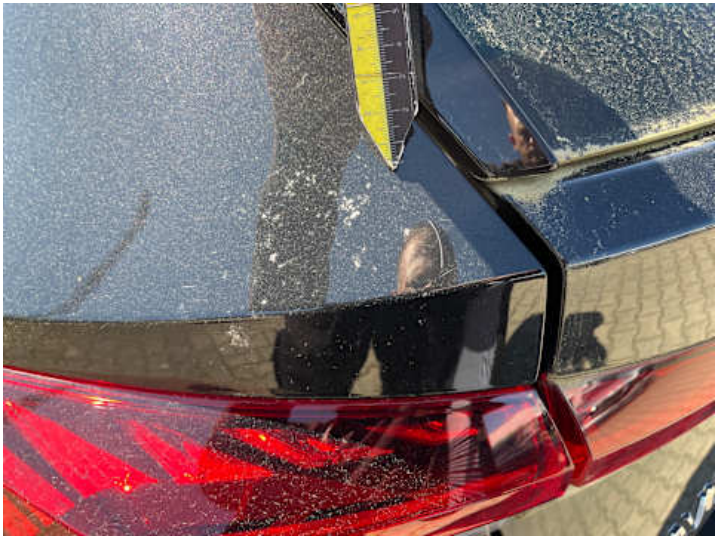
Seitenteil hinten links (Lackschaden, Kratzer)
