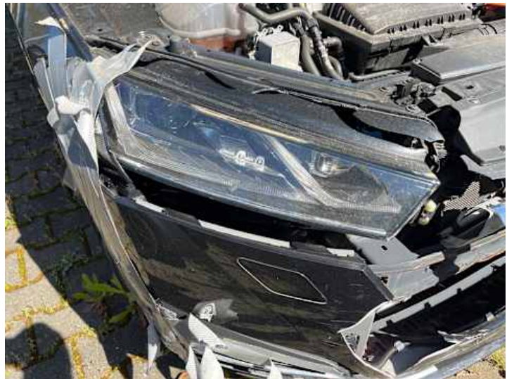
Scheinwerfer (rechts) (Riss/Bruch)
