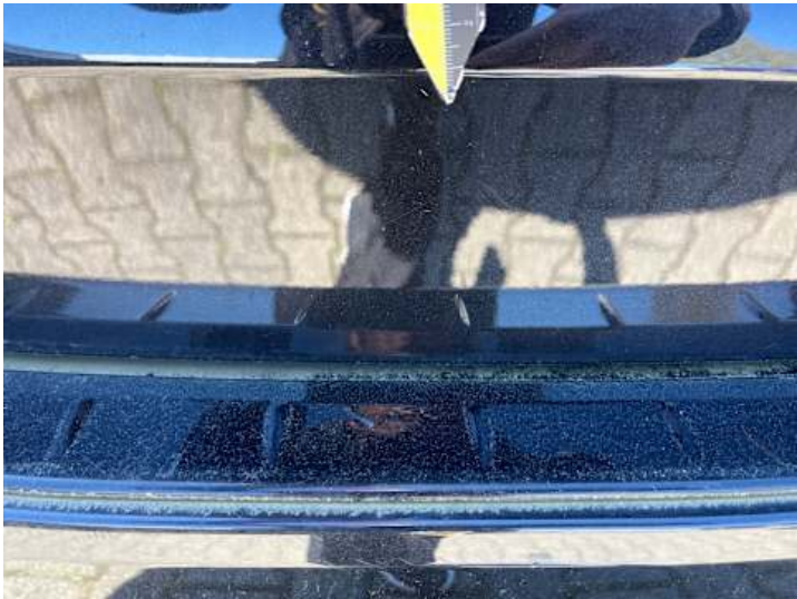
Heckklappe (Lackschaden, Kratzer)
