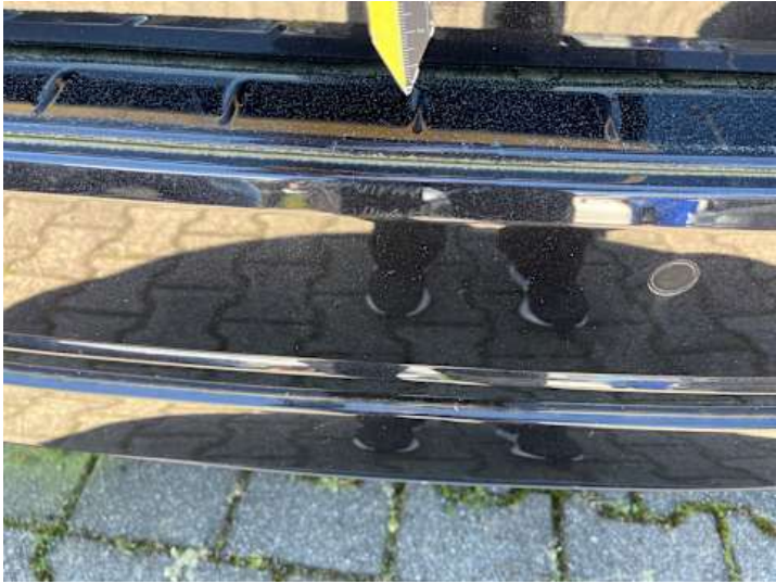
Stoßstange hinten (Lackschaden, Kratzer)
