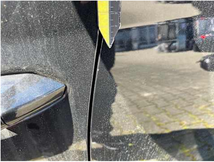
Türe hinten links (Lackschaden, Kratzer)
