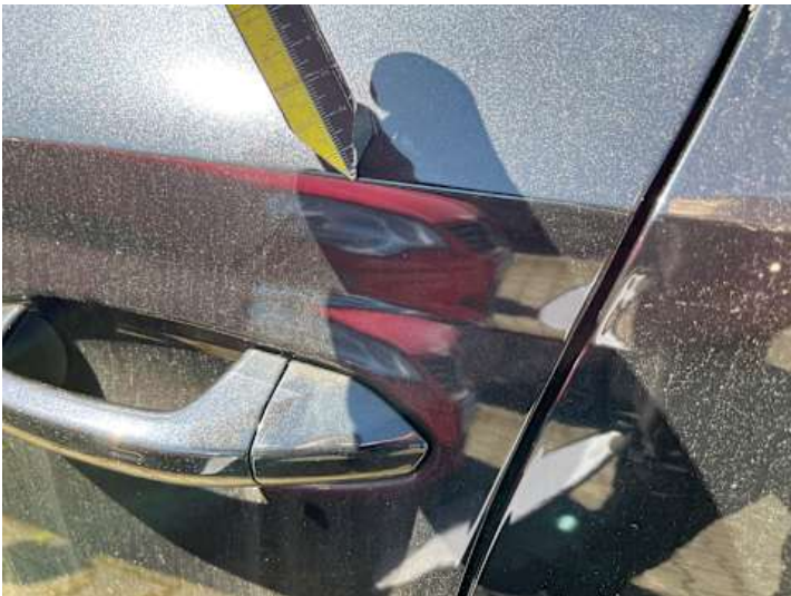
Fahrtür (Lackschaden, Kratzer)
