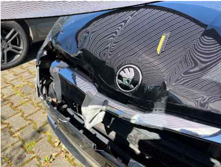
Motorhaube (Lackschaden, Kratzer, Rost, Verformung)
