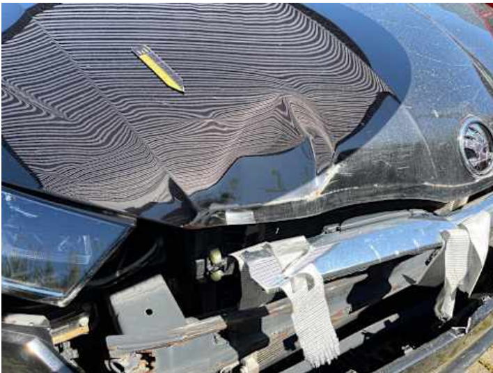
Motorhaube (Lackschaden, Kratzer, Rost, Verformung)
