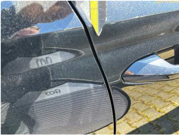
Beifahrertür (Lackschaden, Kratzer)
