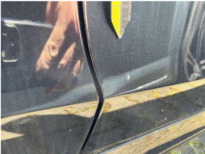
Beifahrtür (Lackschaden, Kratzer)
