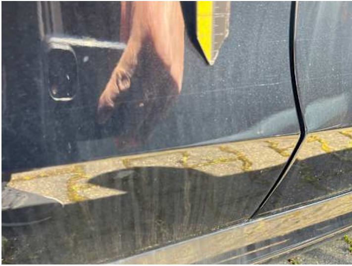
Türe hinten rechts (Lackschaden, Kratzer)
