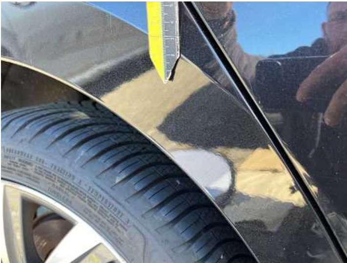
Seitenteil hinten rechts (Lackschaden, Kratzer)
