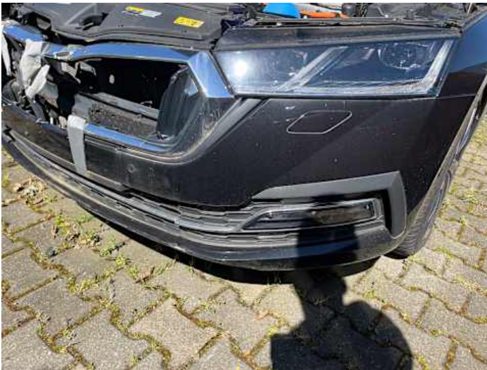
Stoßstange vorne (Lackschaden, Kratzer, Riss/Bruch)
