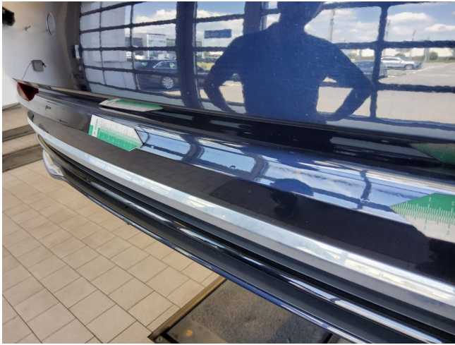
Stoßfänger hinten, eingedellt, smart repair (DEKRA)
