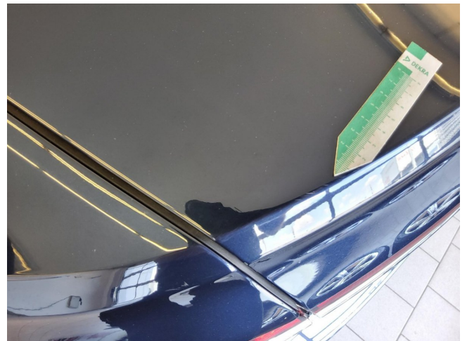
Heckdeckel Kante, zerkratzt, Gebrauchsspur (DEKRA)
