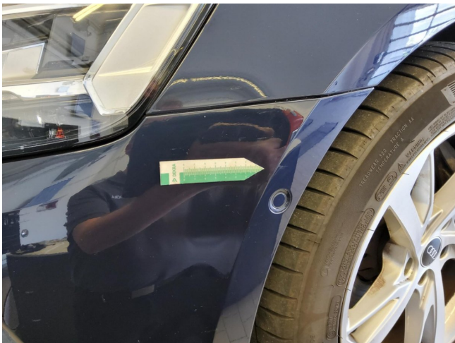
Stoßfänger vorne Lackierung, zerkratzt, Gebrauchsspur (DEKRA)
