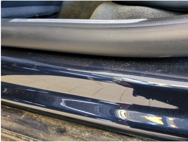
Einstieg hinten links verkratzt (DEKRA)
