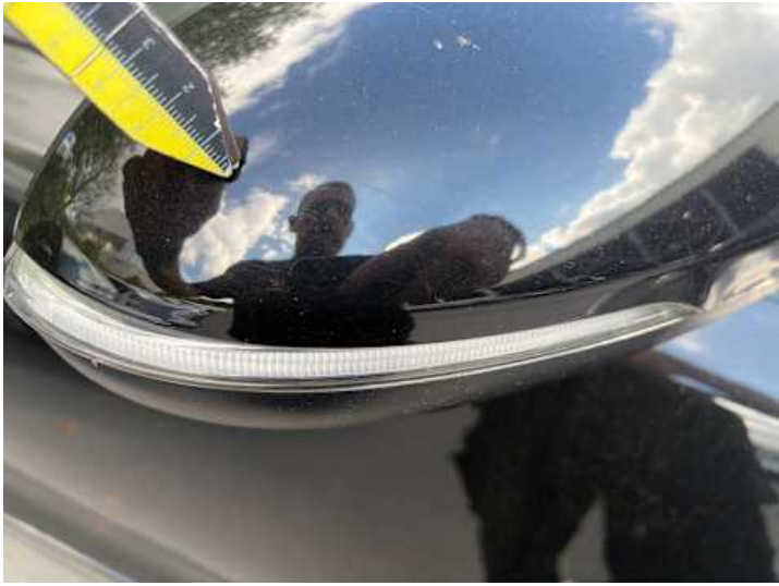
Beifahrtür (Lackschaden, Kratzer)
