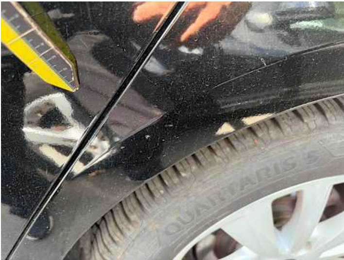
Seitenteil hinten links (Lackschaden, Kratzer)
