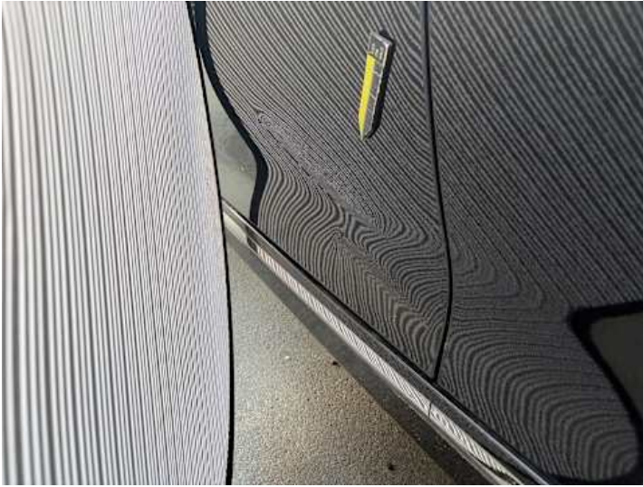
Fahrtür (Delle, Verformung)
