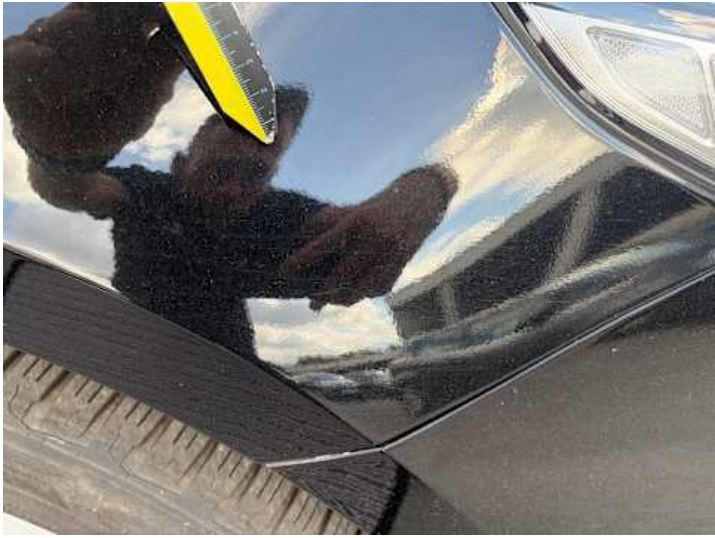
Kotflügel vorne rechts (Lackschaden, Kratzer)
