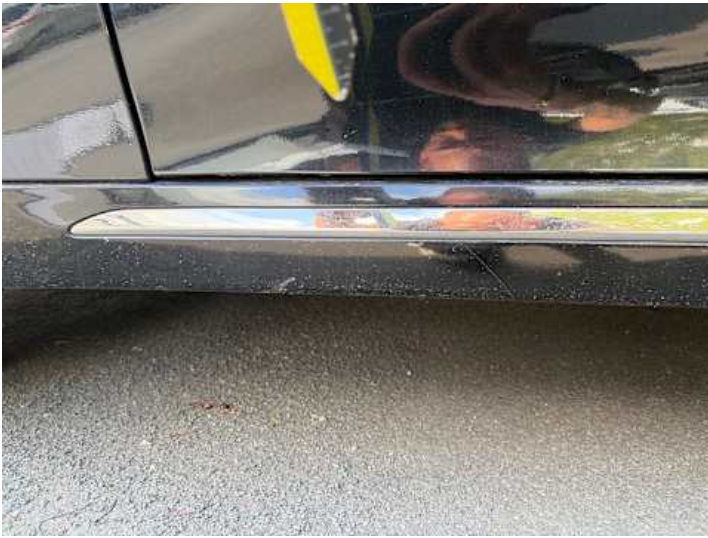
Schweller links (Lackschaden, Kratzer)
