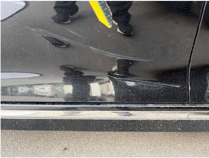
Fahrtür (Lackschaden, Kratzer)
