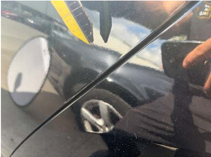
Türe hinten links (Lackschaden, Kratzer)
