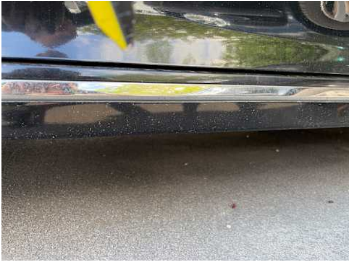
Schweller links (Lackschaden, Kratzer)
