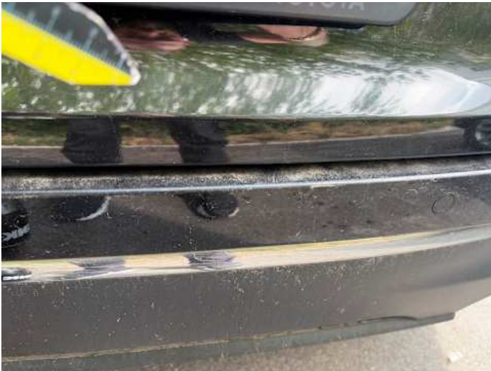
Heckklappe (Lackschaden, Kratzer)
