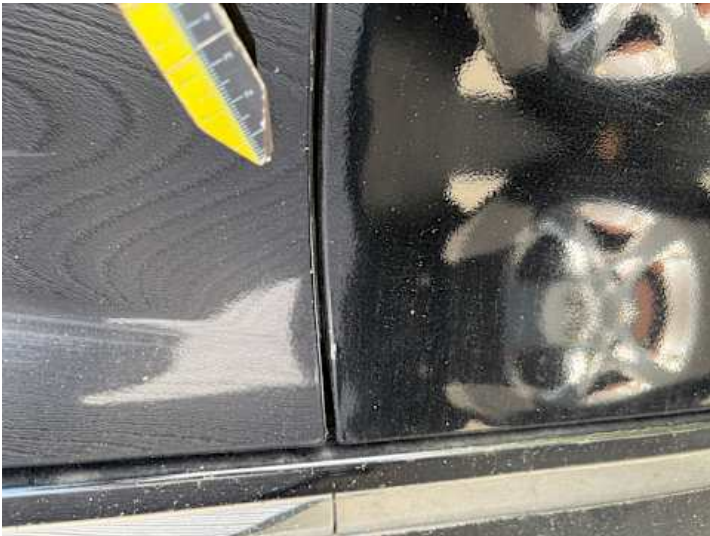
Türe hinten links (Lackschaden, Kratzer)
