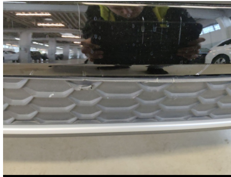
Stoßfängerleiste / Hinten / Kratzer
