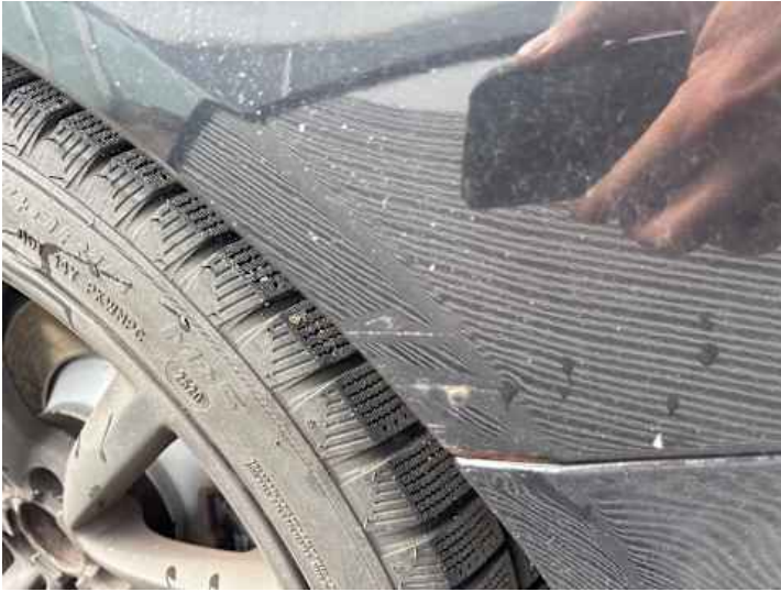
Seitenteil hinten links (Rost, Kratzer)
