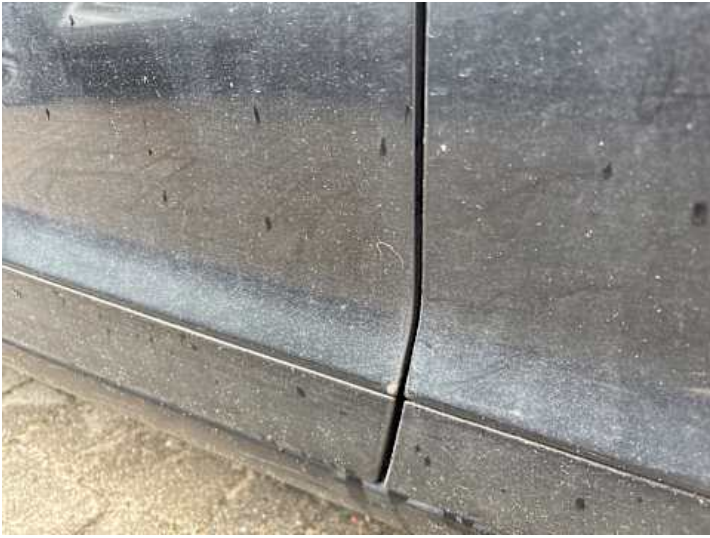
Türe hinten rechts (Rost)
