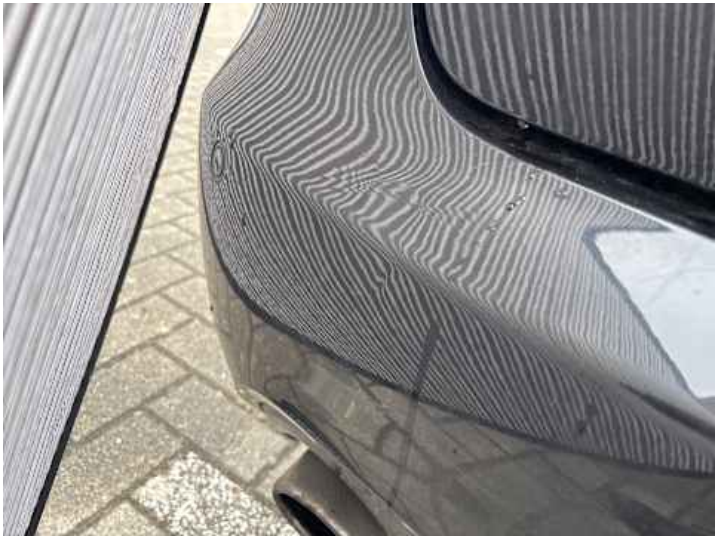
Stoßstange hinten (Verformung)
