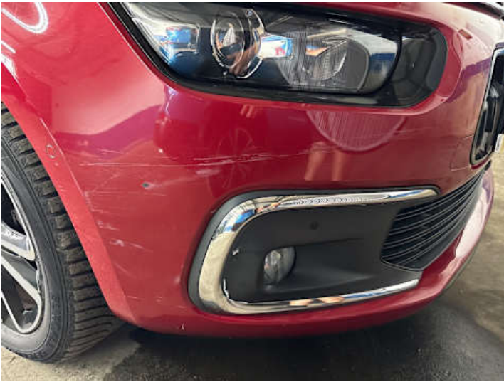
Stoßstange vorne (Kratzer, Verformung, Riss/Bruch)
