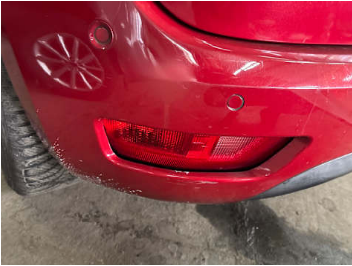
Stoßstange hinten (Kratzer, Verformung)
