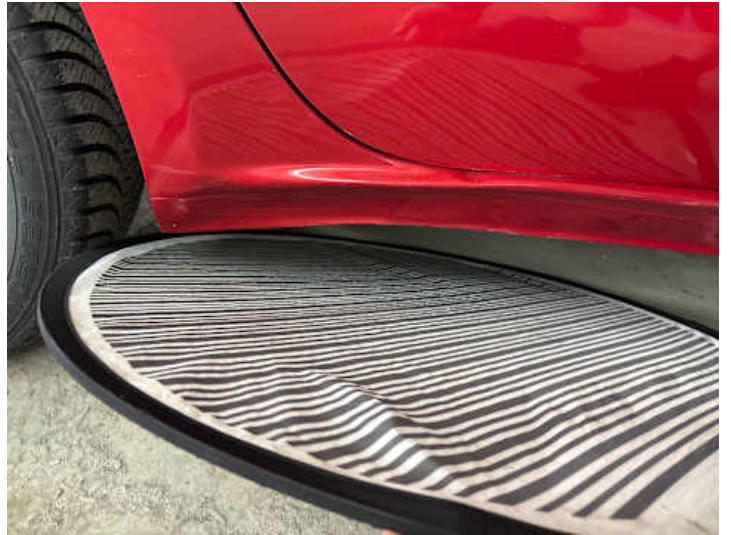
Schweller rechts (Verformung, Kratzer)
