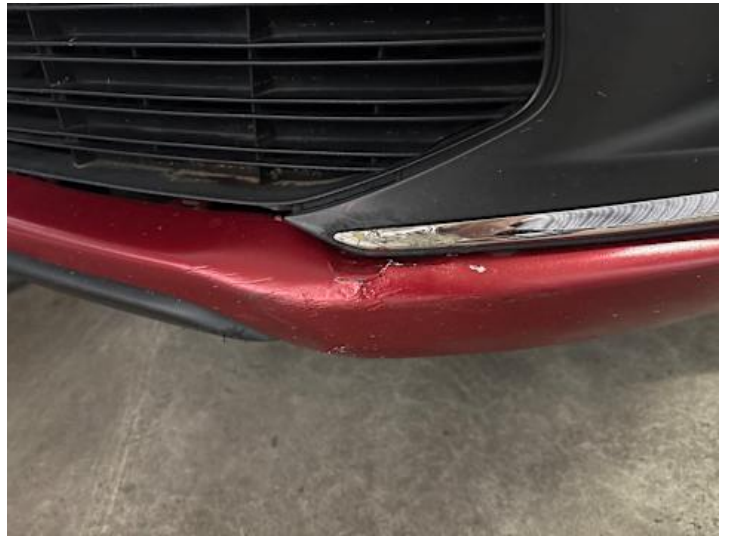
Stoßstange vorne (Kratzer, Verformung, Riss/Bruch)
