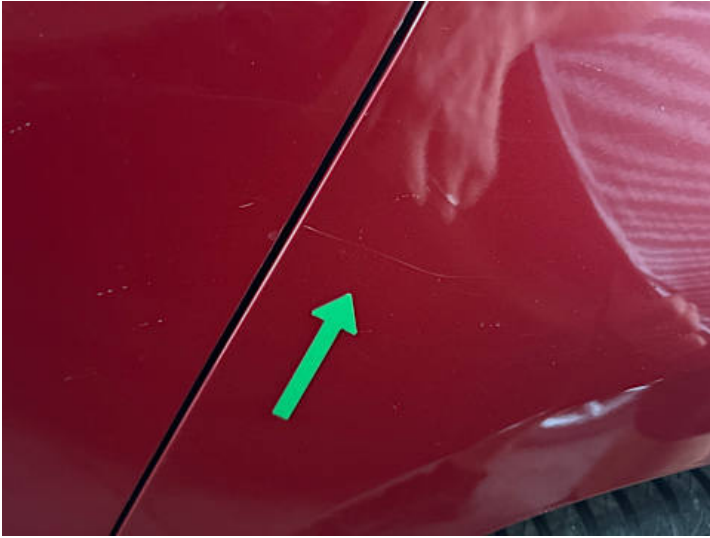
Seitenteil hinten links (Kratzer)
