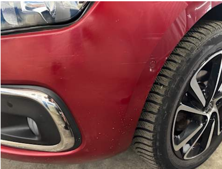
Stoßstange vorne (Kratzer, Verformung, Riss/Bruch)
