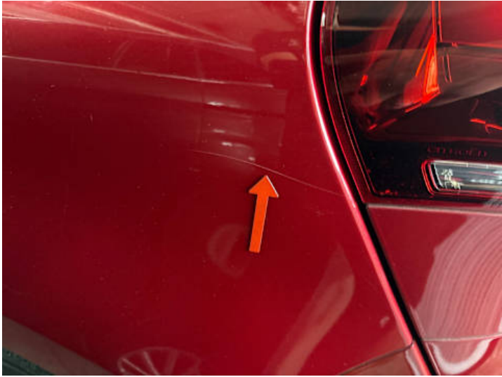
Seitenteil hinten links (Kratzer)
