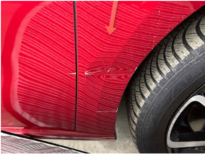
Kotflügel vorne rechts (Verformung, Kratzer)
