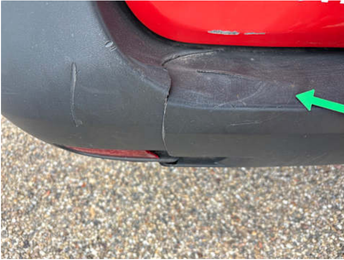
Stoßstange hinten (Riss/Bruch)
