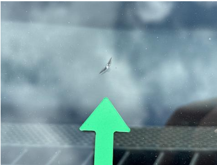
Windschutzscheibe (Steinschlag, Riss/Bruch)
