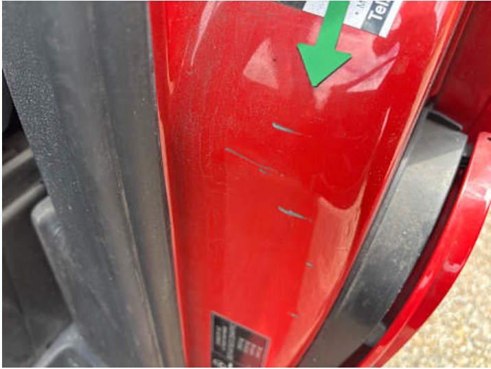
Schweller links (Kratzer, Delle)
