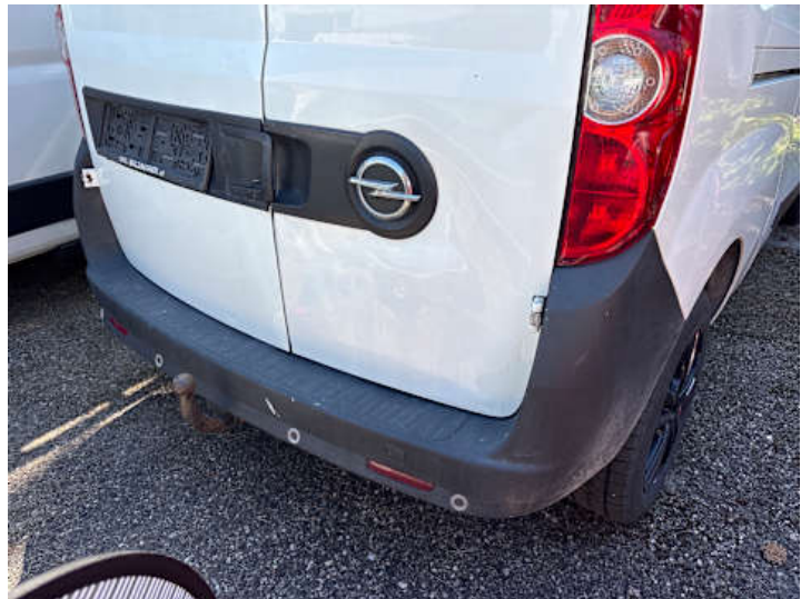
Heckklappe (Verformung, Delle)
