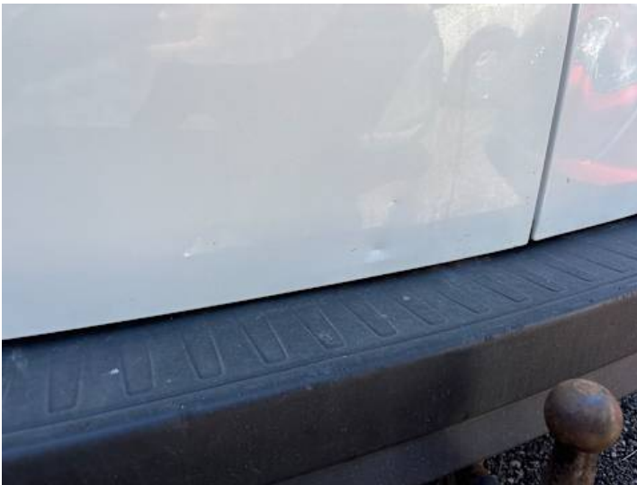
Heckklappe (Verformung, Delle)
