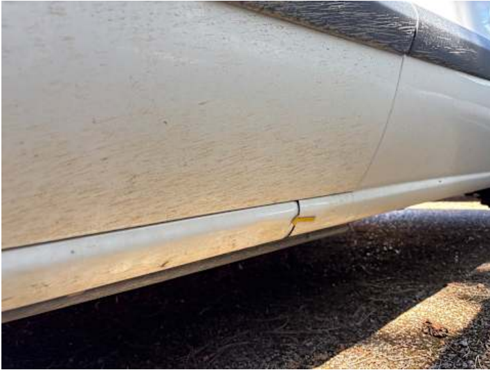
Schweller links (Delle)
