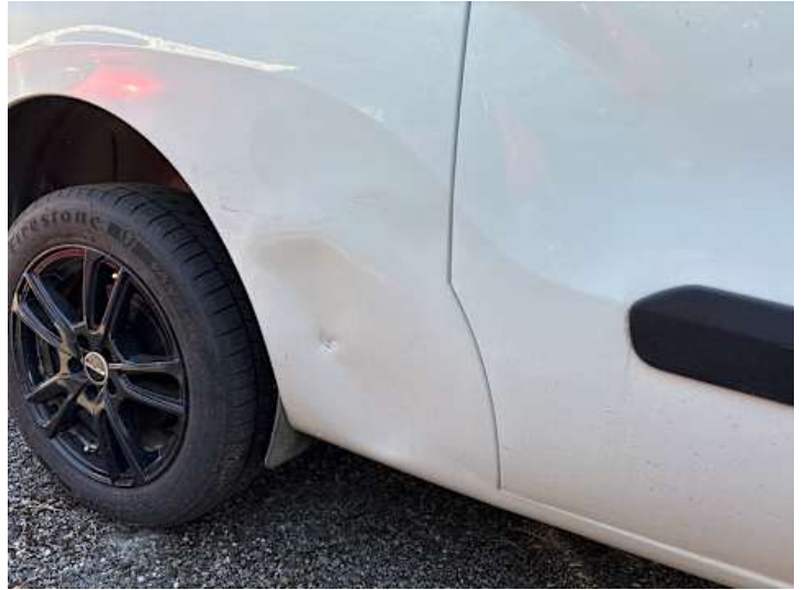
Seitenteil hinten rechts (Delle, Verformung, Kratzer, Lackschaden)
