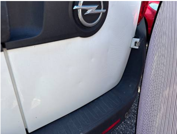
Heckklappe (Verformung, Delle)
