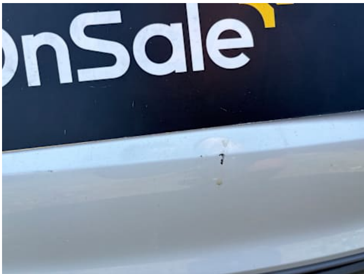
Stoßstange hinten (Kratzer, Verformung)
