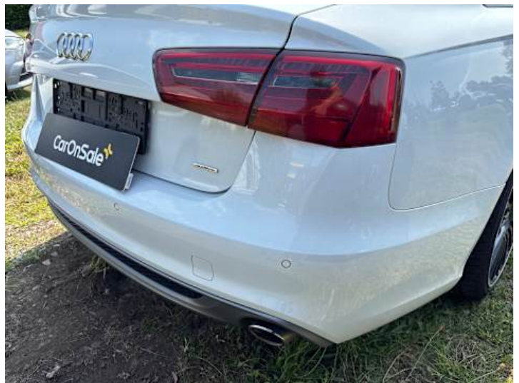
Stoßstange hinten (Kratzer, Verformung)
