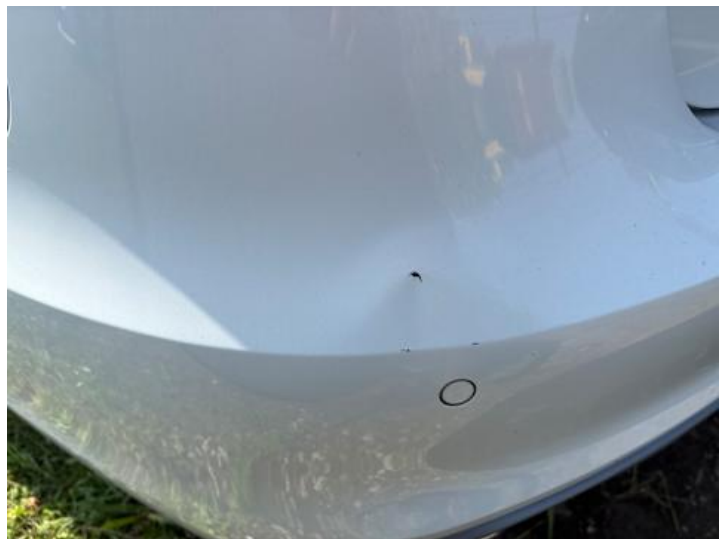
Stoßstange hinten (Kratzer, Verformung)
