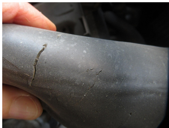
Bild 2: Innen, Motorraum , Tierverschiss, Rep.-Kosten geschätzt (ges. GA erforderlich)
