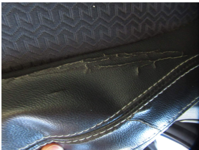
Bild 7: Innen, Sitz- und Lehnenbezug vorn links, gerissen, erneuern
