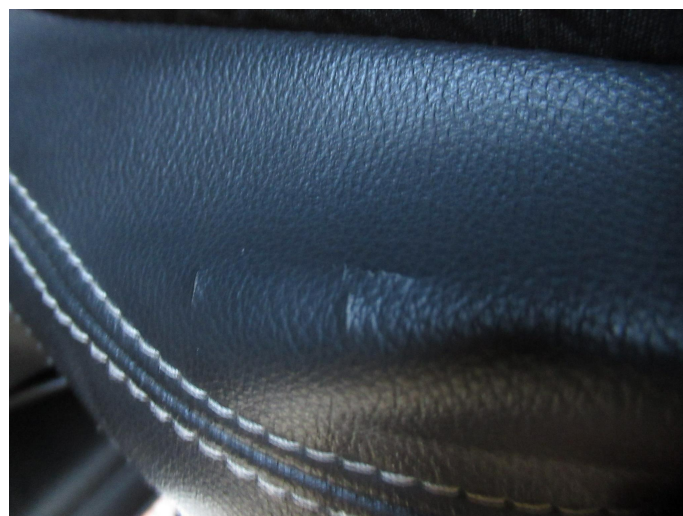
Bild 6: Innen, Sitz vorne rechts - Sitzbezug, gerissen, erneuern
