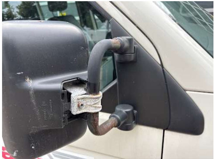
Beifahrtür (Verformung, Rost)
