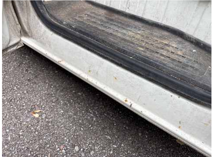
Schweller links (Rost)
