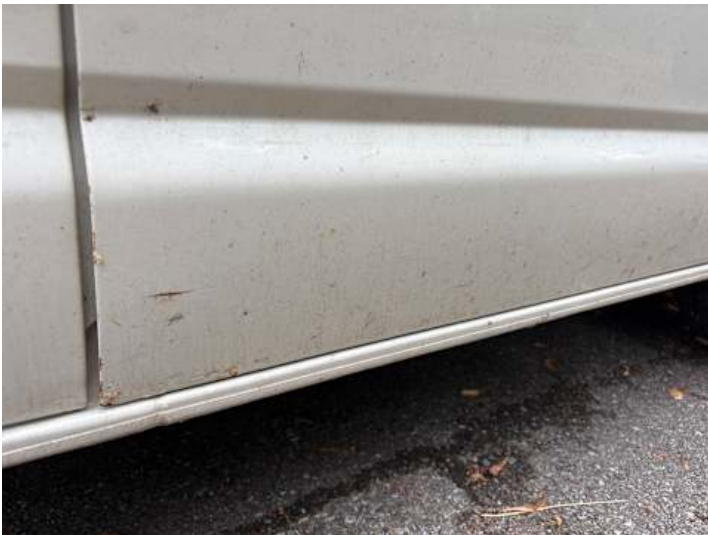
Beifahrtür (Verformung, Rost)
