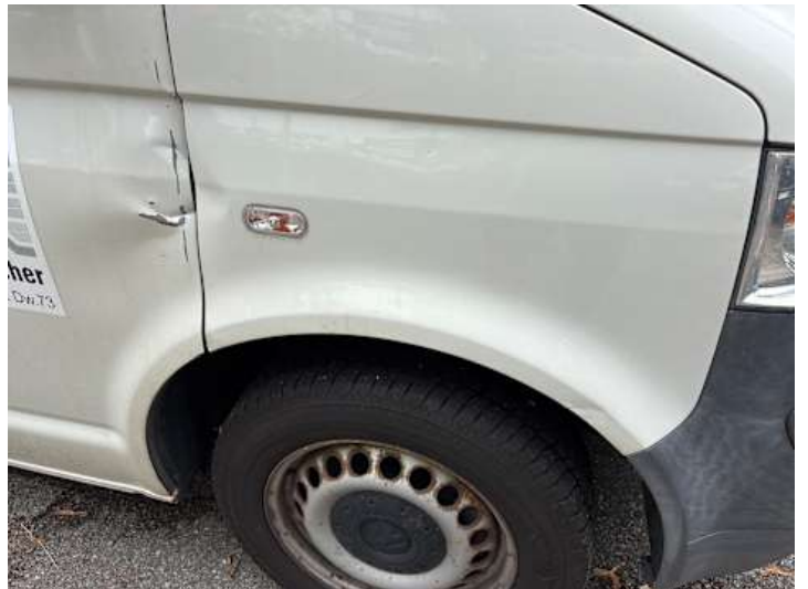
Kotflügel vorne rechts (Verformung)
