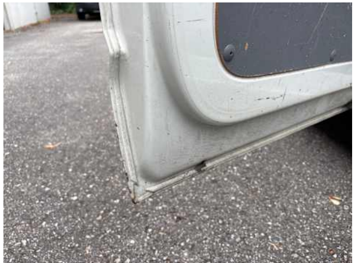
Türe hinten links (Rost)
