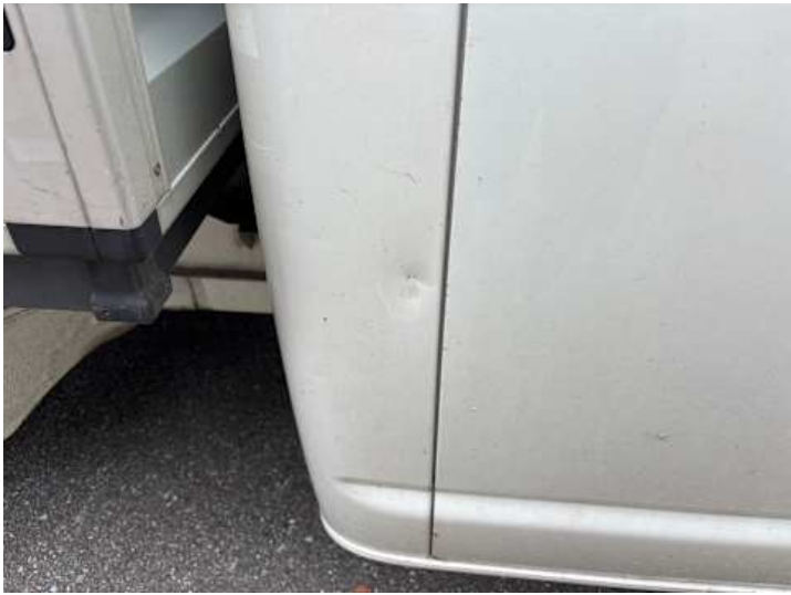
Seitenteil hinten rechts (Delle, Rost)
