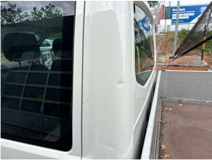
Seitenteil hinten links (Delle, Rost)
