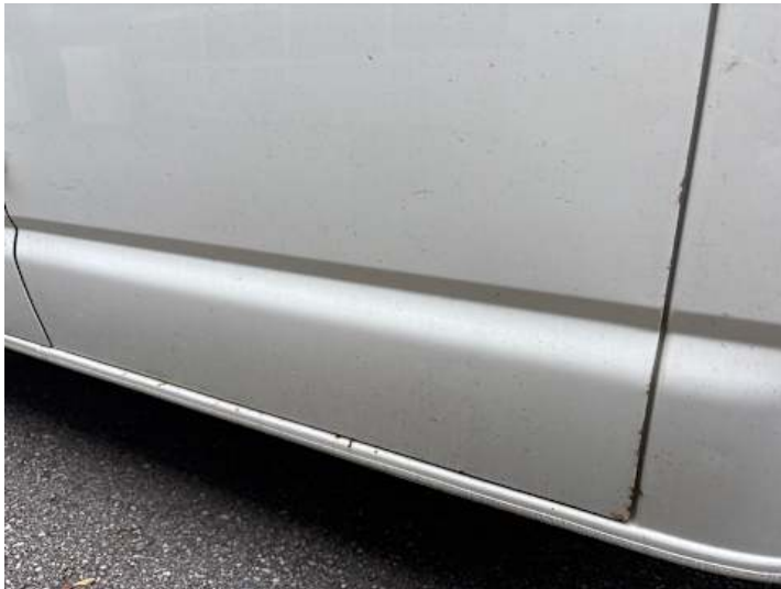
Türe hinten links (Rost)
