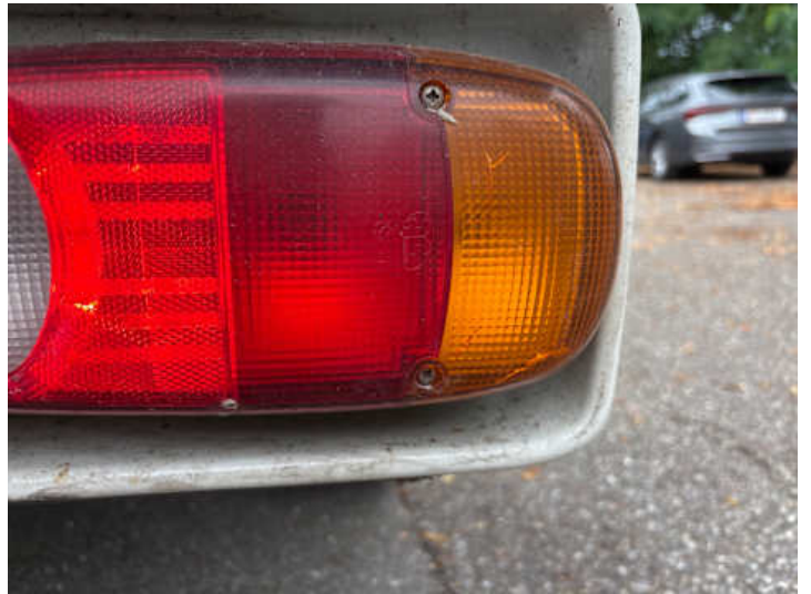
Rücklicht (rechts) (Riss/Bruch)
