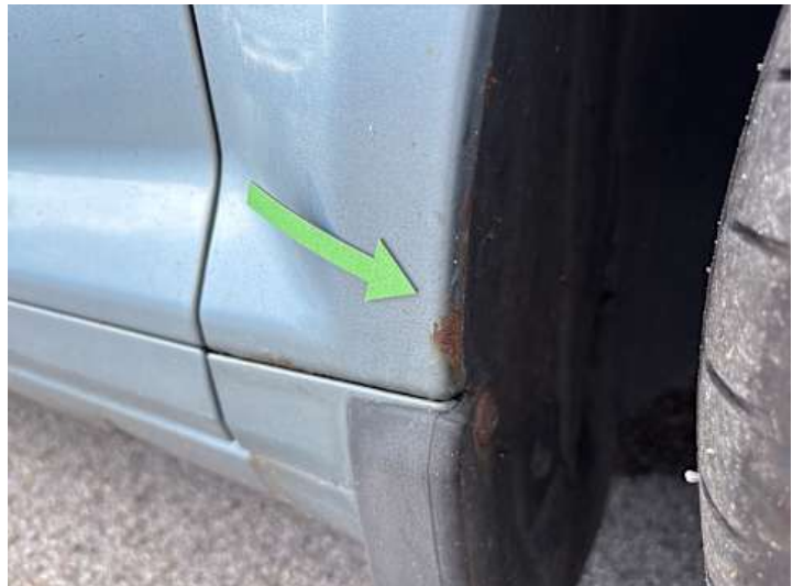
Kotflügel vorne rechts (Rost)
