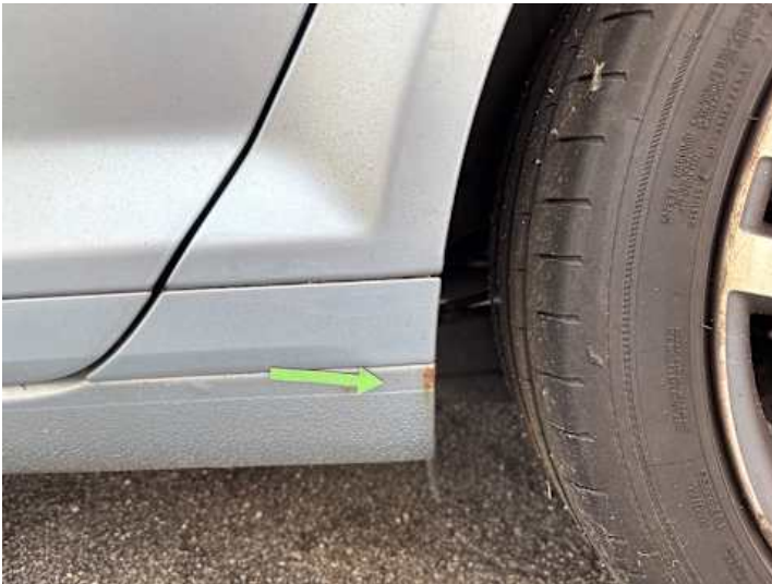
Schweller links (Rost)
