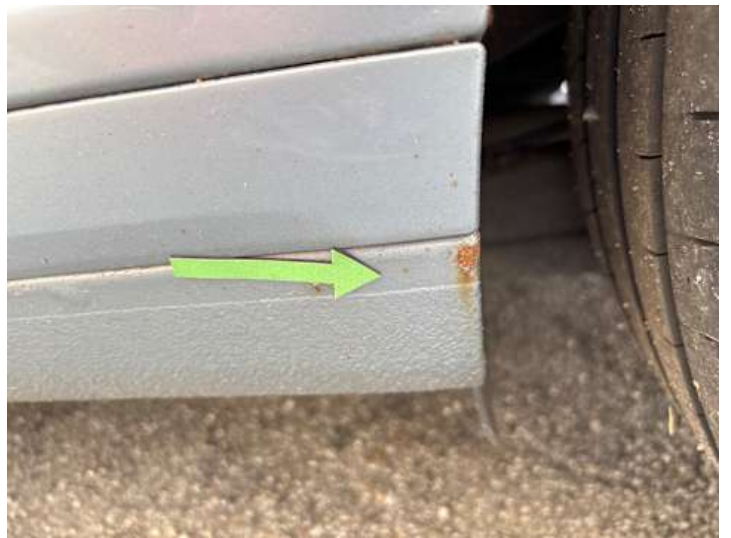
Schweller links (Rost)
