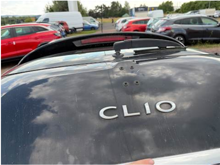
Heckklappe (Kratzer, Rost)
