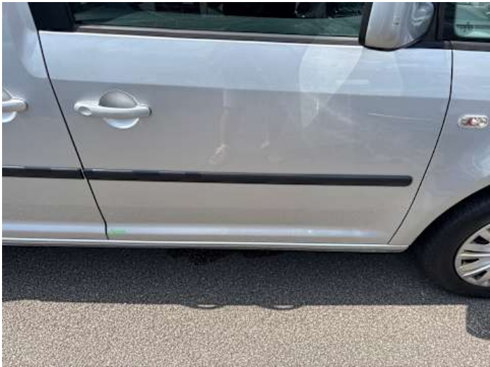
Beifahrtür (Kratzer, Rost)
