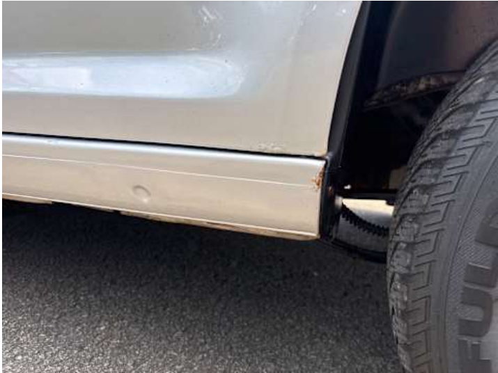
Schweller links (Rost)
