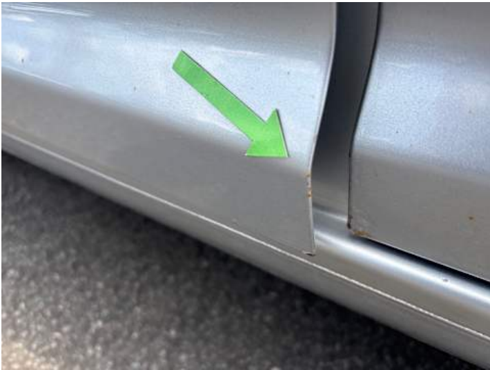
Fahrtür (Rost, Kratzer)
