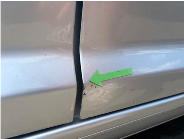
Beifahrtür (Kratzer, Rost)
