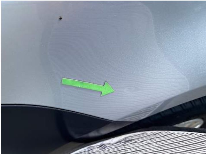
Kotflügel vorne links (Delle)
