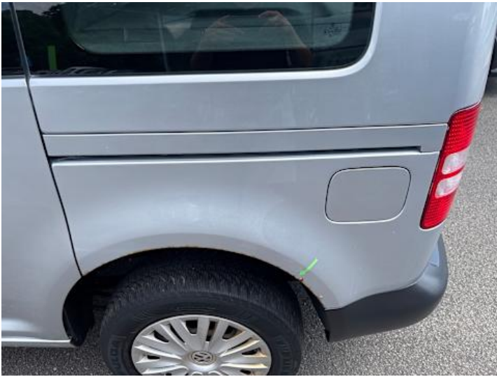
Seitenteil hinten links (Rost)
