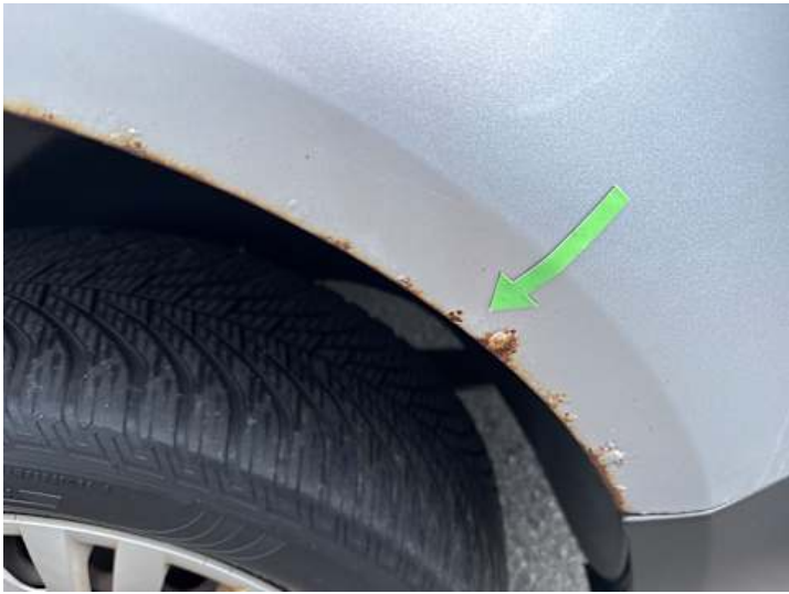
Seitenteil hinten links (Rost)
