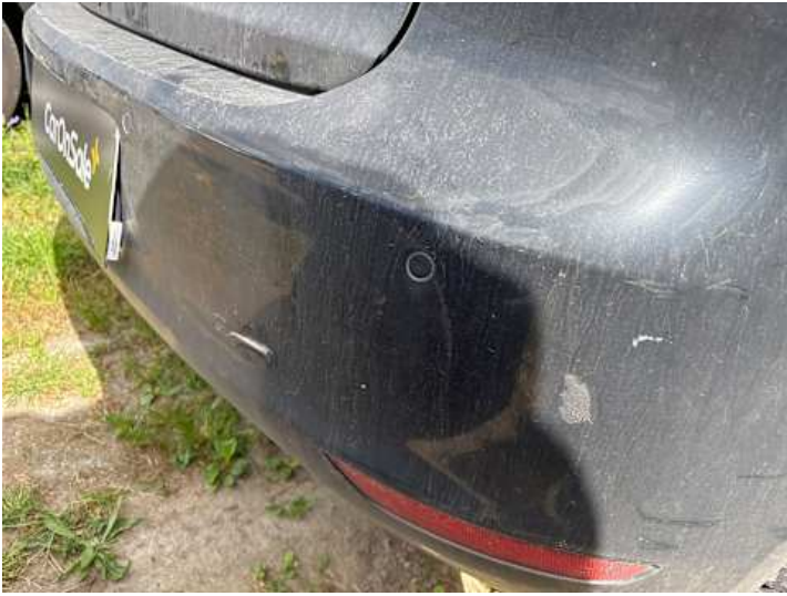
Stoßstange hinten (Riss/Bruch)
