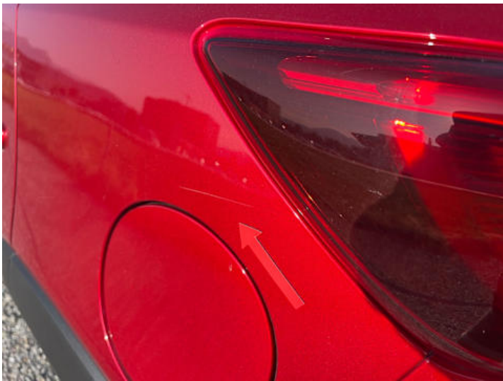
Seitenteil hinten links (Lackschaden)
