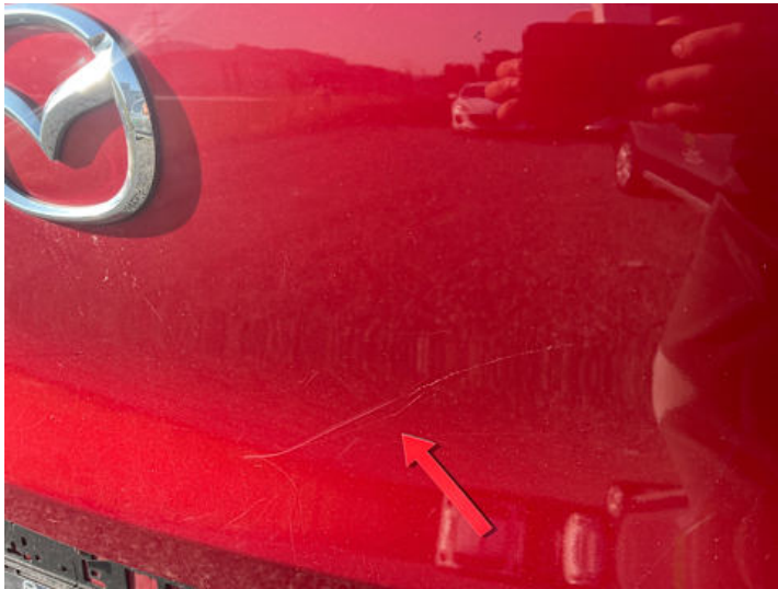
Heckklappe (Lackschaden, Kratzer)
