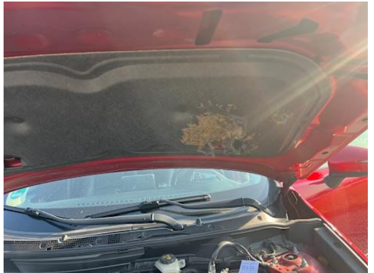
Motorhaube (Anderer Schaden): Dämmmatte defekt
