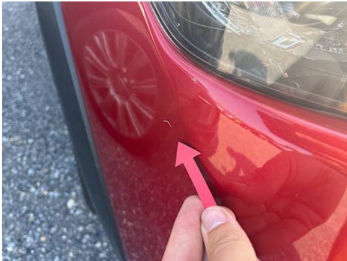
Stoßstange vorne (Lackschaden)
