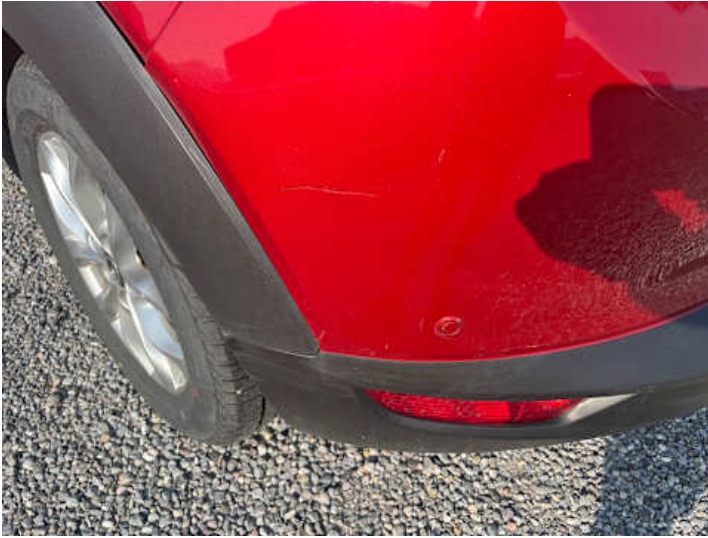
Stoßstange hinten (Kratzer, Lackschaden)
