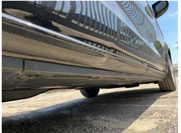
Schweller rechts (Verformung, Kratzer)
