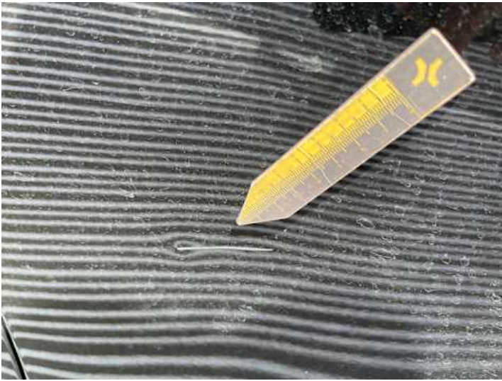
Beifahrertür (Kratzer, Delle)
