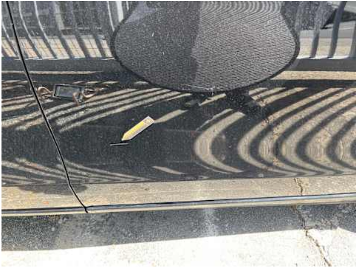
Beifahrertür (Kratzer, Delle)
