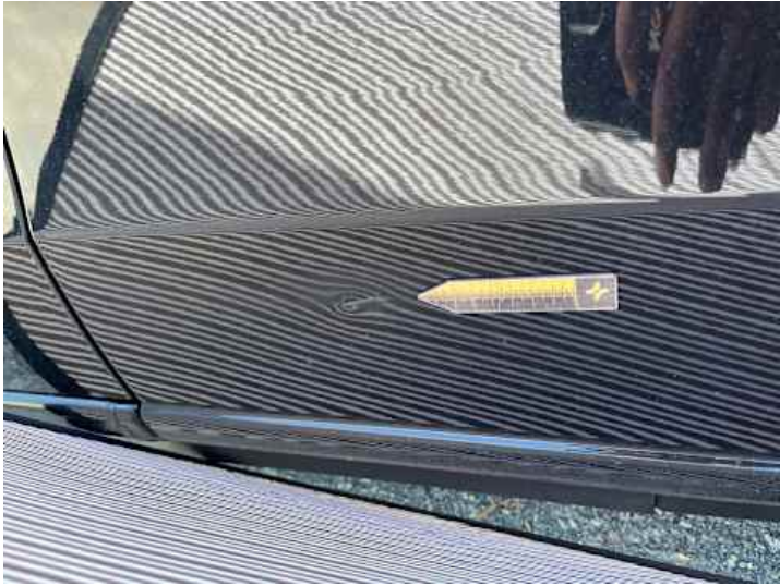
Türe hinten links (Kratzer, Delle)
