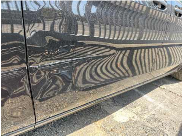
Türe hinten rechts (Verformung, Kratzer)
