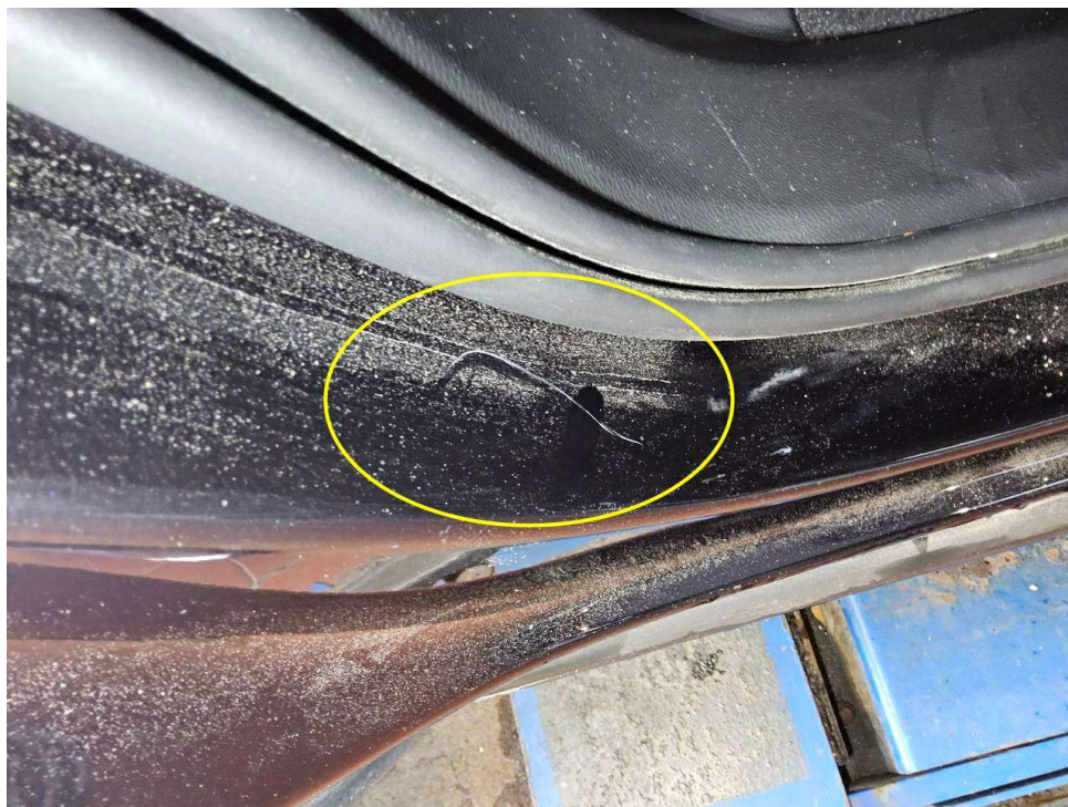
Bild 7 : Türeinstieg hinten rechts verkratzt
