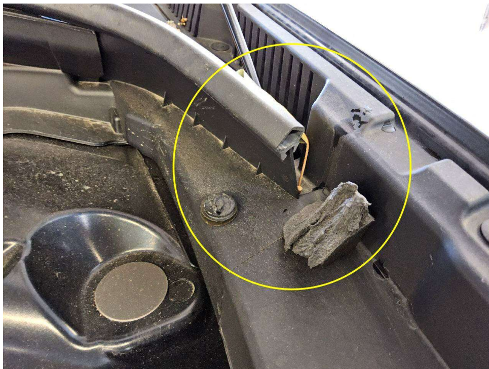
Bild 13 : Motorraumabdichtung links, mittig und rechts Tierversbiss
