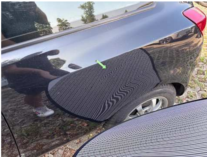
Seitenteil hinten links (Verformung)
