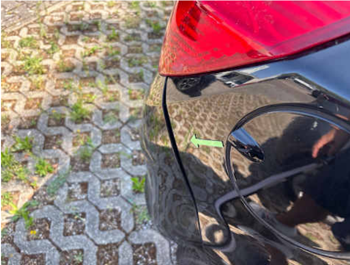
Stoßstange hinten (Spaltmaße ungenau)
