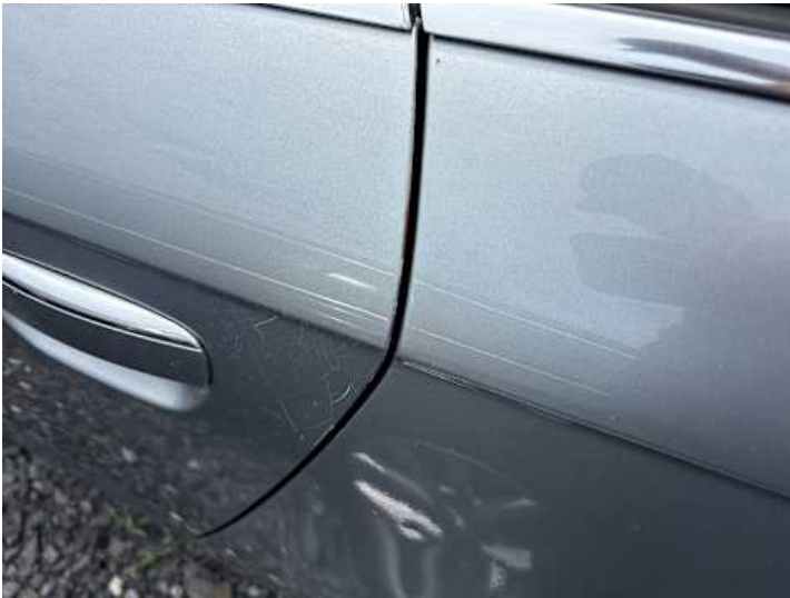
Türe hinten links (Kratzer, Lackschaden, Rost)
