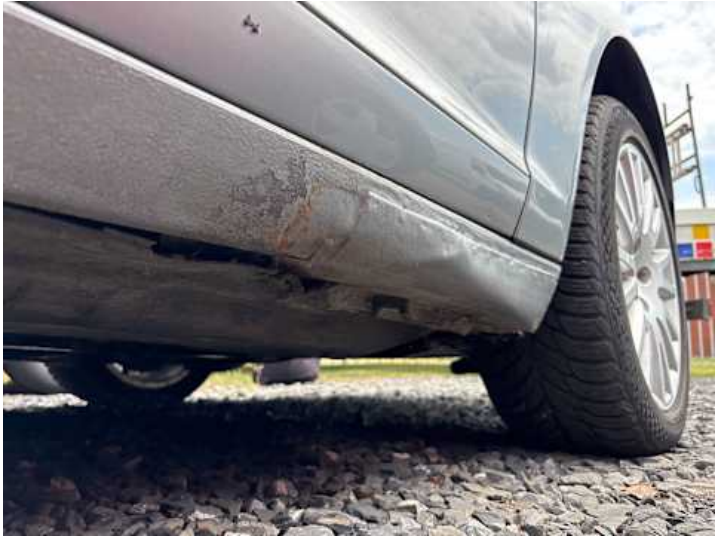
Schweller rechts (Lackschaden, Kratzer, Rost, Verformung, Unsachgemäß instand gesetzt)
