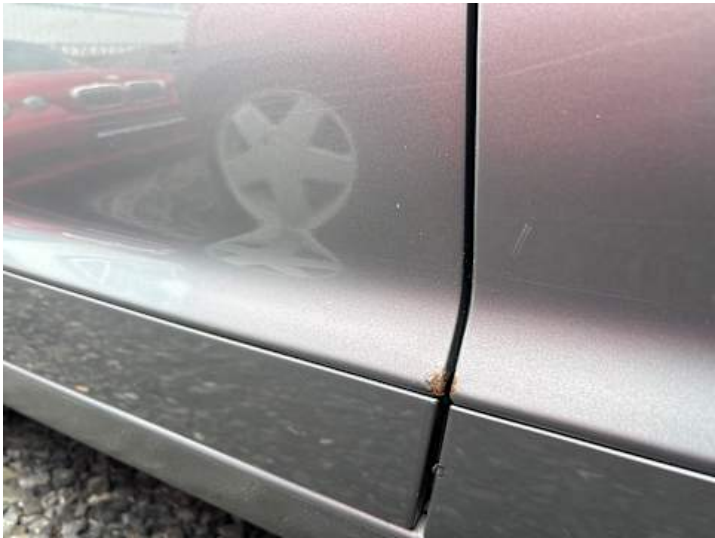
Türe hinten rechts (Lackschaden, Rost)
