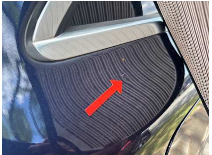
Seitenteil hinten rechts (Delle, Verformung)
