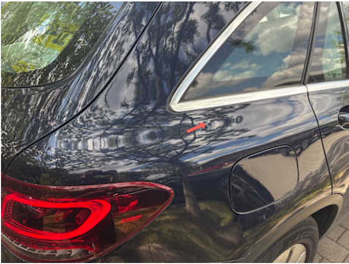
Seitenteil hinten rechts (Delle, Verformung)
