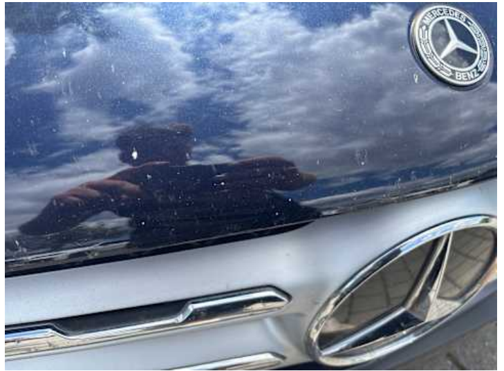
Motorhaube (Lackschaden, Steinschlag)
