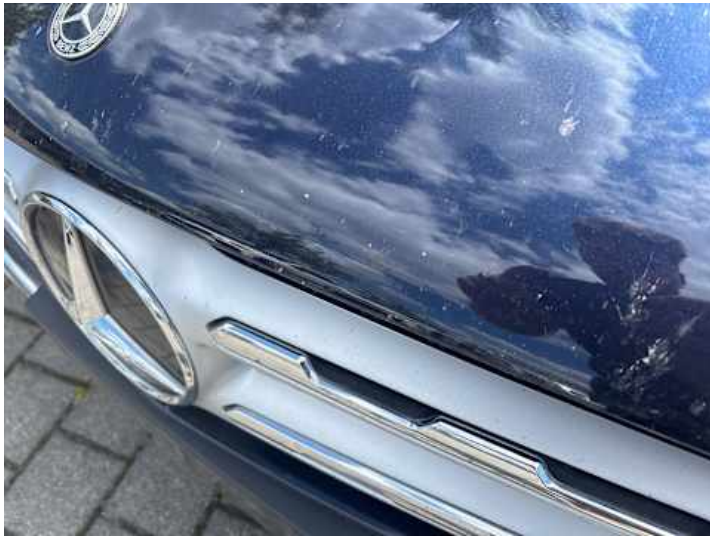
Motorhaube (Lackschaden, Steinschlag)
