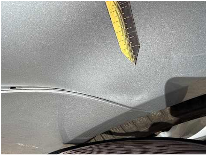
Kotflügel vorne links (Delle)
