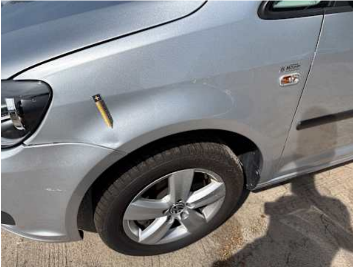
Kotflügel vorne links (Delle)
