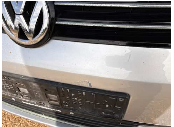
Stoßstange vorne (Lackschaden)
