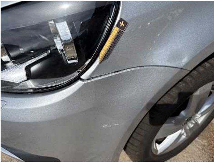
Stoßstange vorne (Spaltmaße ungenau)
