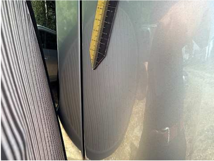
Seitenteil hinten rechts (Delle)
