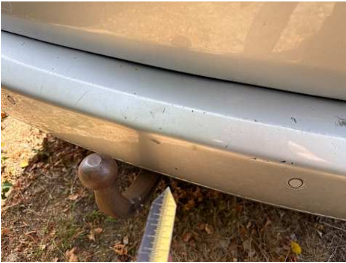
Stoßstange hinten (Lackschaden)
