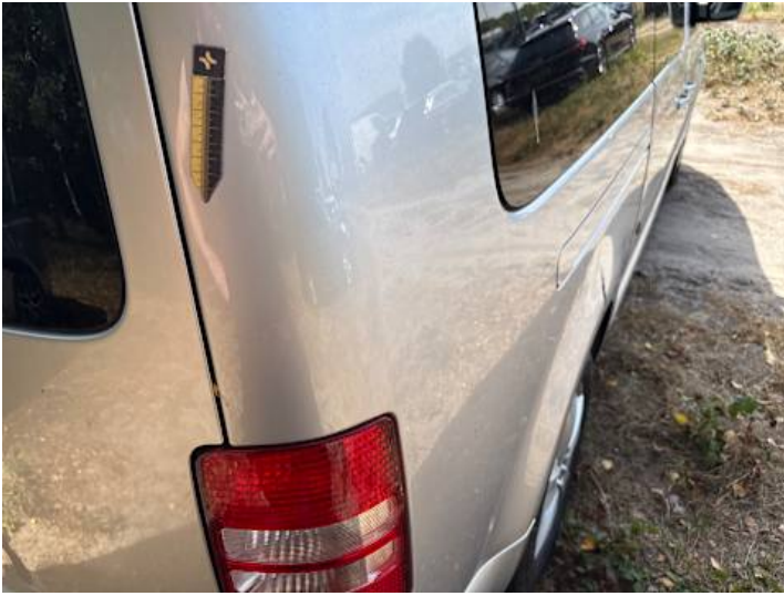
Seitenteil hinten rechts (Delle)
