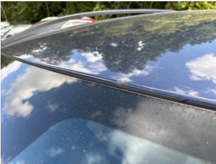
Dach (Rost, Kratzer)
