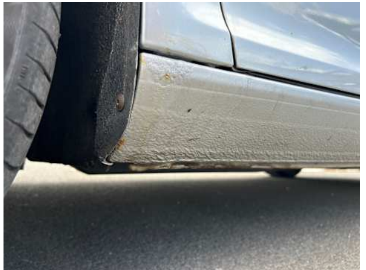
Schweller links (Rost)
