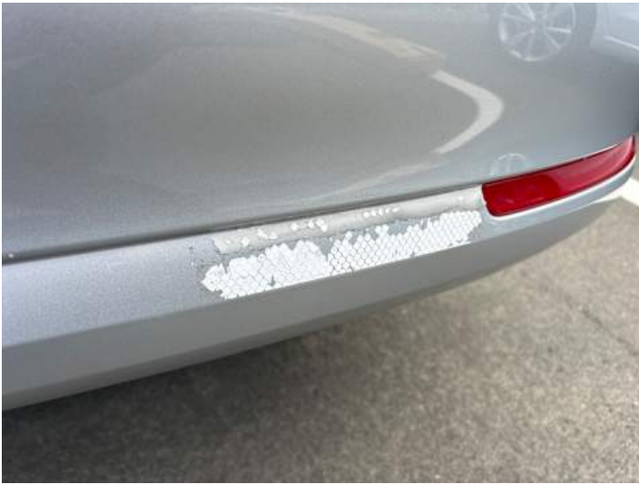
Stoßstange hinten (Lackschaden)
