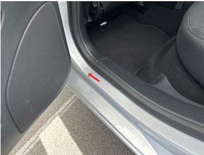
Schweller links (Delle)
