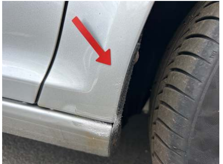
Kotflügel vorne rechts (Rost, Unsachgemäß instand gesetzt)
