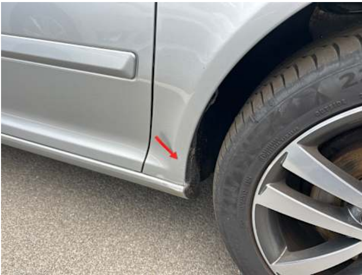
Kotflügel vorne rechts (Rost, Unsachgemäß instand gesetzt)
