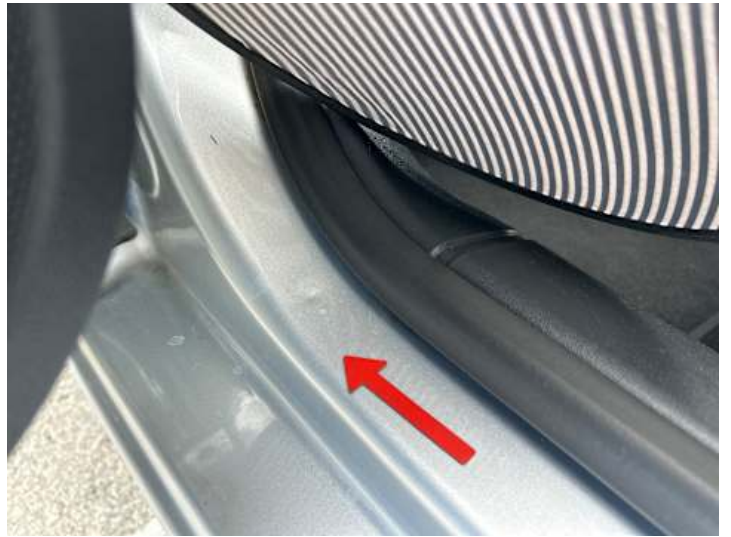
Schweller links (Delle)
