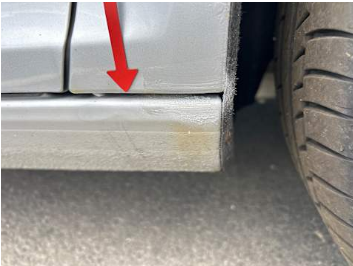
Schweller rechts (Unsachgemäß instand gesetzt, Rost)
