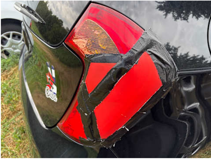
Rücklicht (rechts) (Riss/Bruch)
