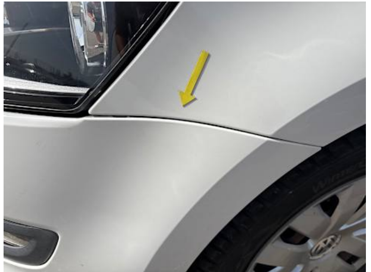
Stoßstange vorne (Spaltmaße ungenau)
