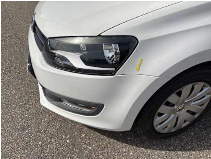
Stoßstange vorne (Spaltmaße ungenau)
