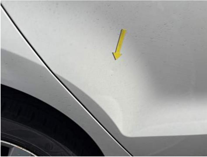
Türe hinten rechts (Delle)
