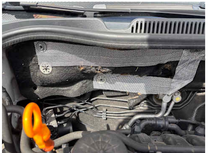
Motorhaube (Anderer Schaden): Mardrrspuren
