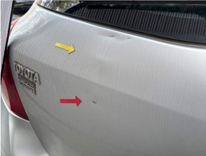
Heckklappe (Lackschaden, Rost, Verformung)
