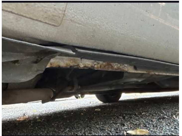
Schweller rechts (Rost)
