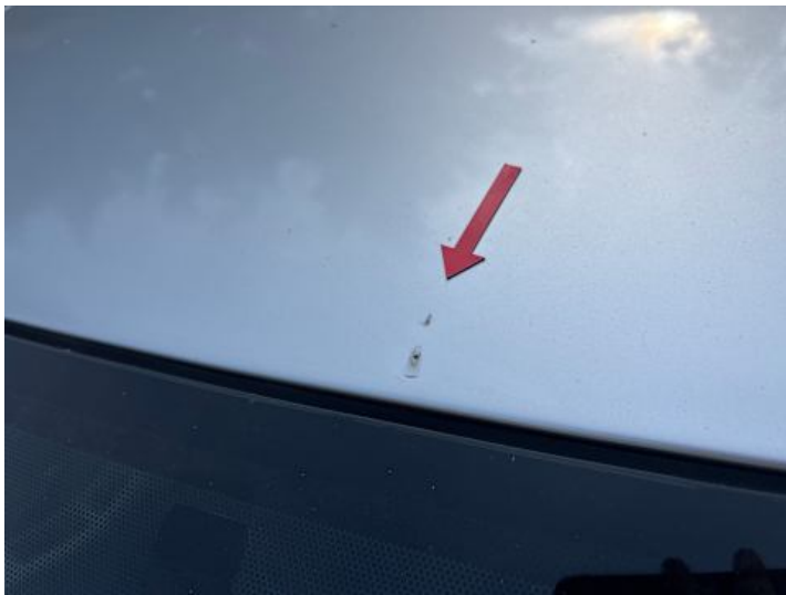
Dach (Lackschaden, Rost)
