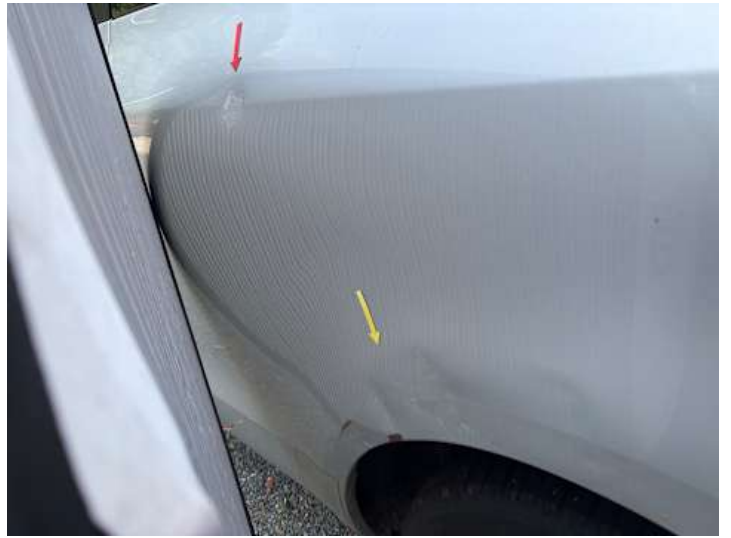
Seitenteil hinten links (Verformung, Delle, Rost, Lackschaden)
