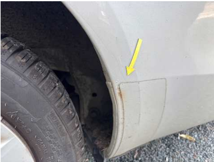
Seitenteil hinten rechts (Rost)
