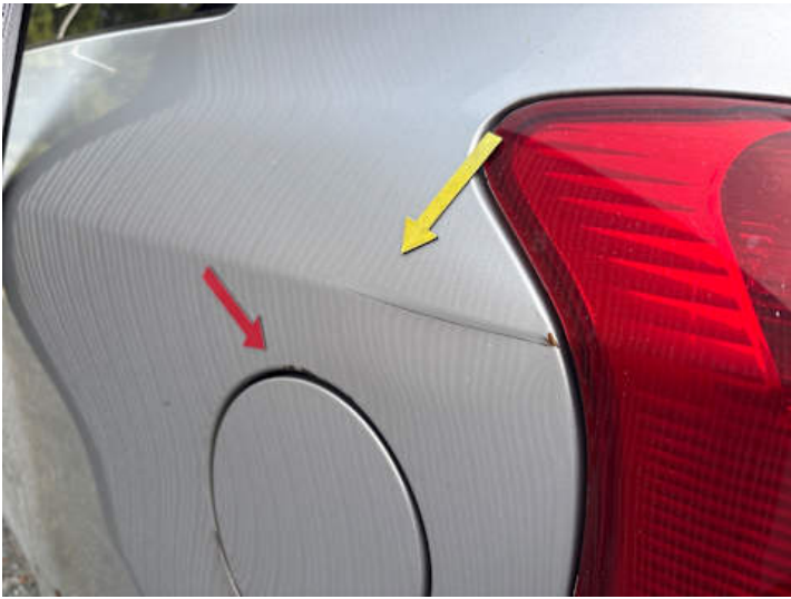
Seitenteil hinten links (Verformung, Lackschaden, Rost)
