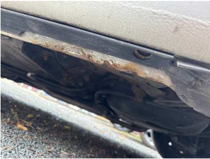
Schweller links (Rost)
