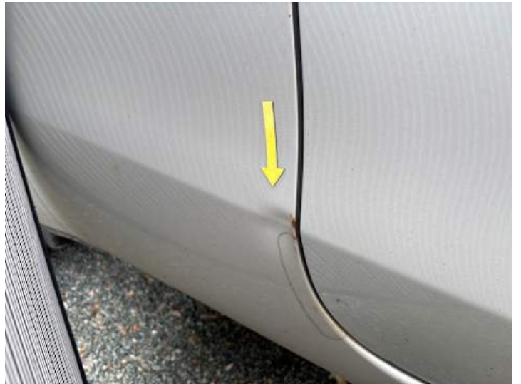
Seitenteil hinten rechts (Rost, Verformung, Lackschaden)
