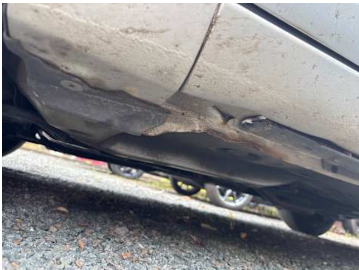
Schweller links (Rost, Verformung)
