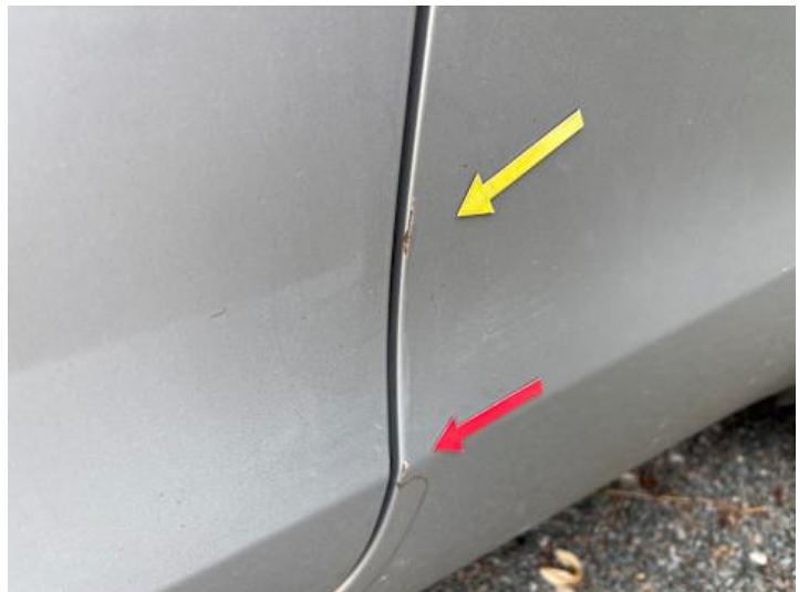
Seitenteil hinten links (Lackschaden, Rost)
