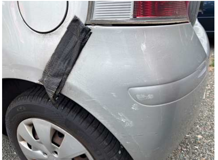
Stoßstange hinten (Riss/Bruch, Lackschaden, Kratzer)
