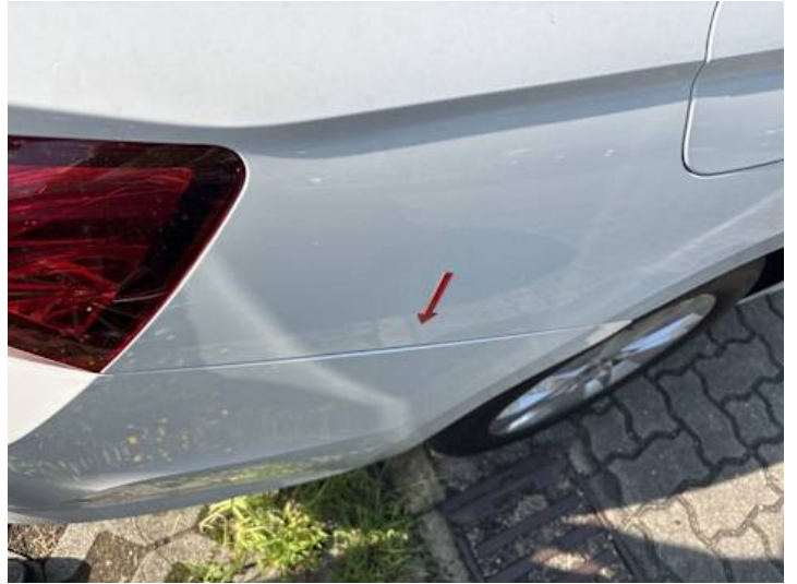
Stoßstange hinten (Spaltmaße ungenau)
