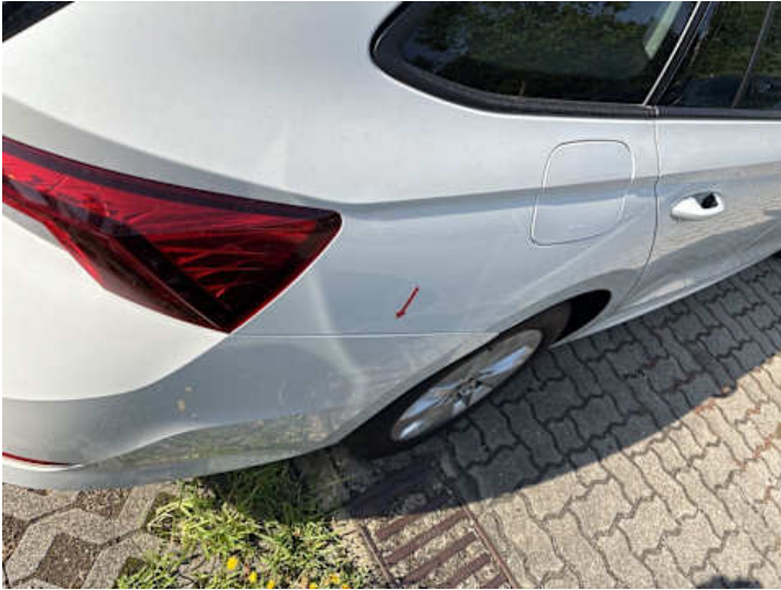
Stoßstange hinten (Spaltmaße ungenau)
