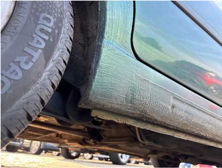
Seitenteil hinten rechts (Unsachgemäß instand gesetzt, Lackschaden, Rost)
