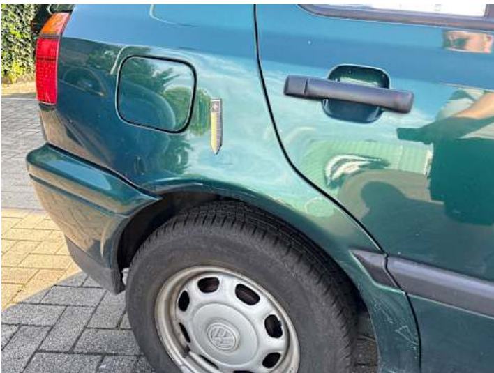
Seitenteil hinten rechts (Lackschaden)
