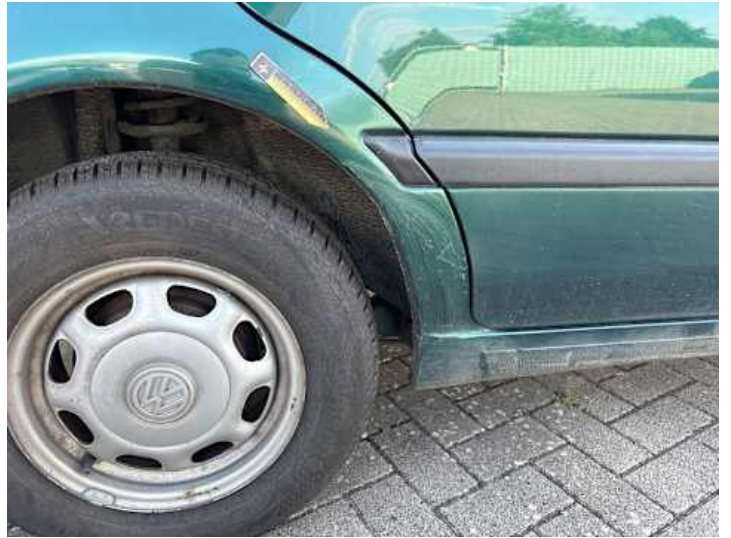
Seitenteil hinten rechts (Unsachgemäß instand gesetzt, Lackschaden, Rost)
