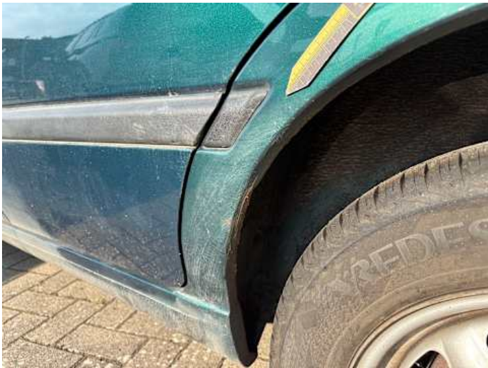
Seitenteil hinten links (Kratzer, Lackschaden, Rost, Unsachgemäß instand gesetzt)
