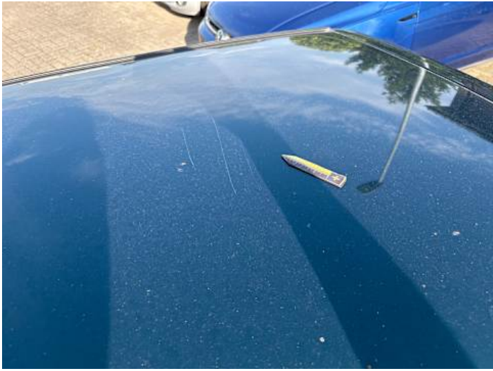
Dach (Delle, Kratzer)
