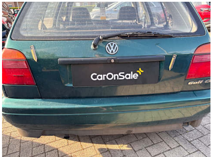
Heckklappe (Lackschaden, Kratzer)
