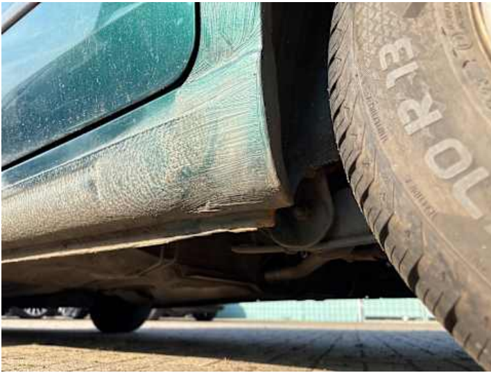
Seitenteil hinten links (Kratzer, Lackschaden, Rost, Unsachgemäß instand gesetzt)
