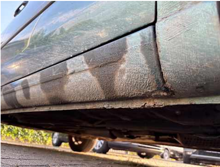
Schweller rechts (Rost)
