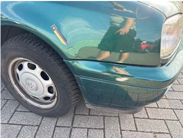
Kotflügel vorne rechts (Unsachgemäß instand gesetzt)
