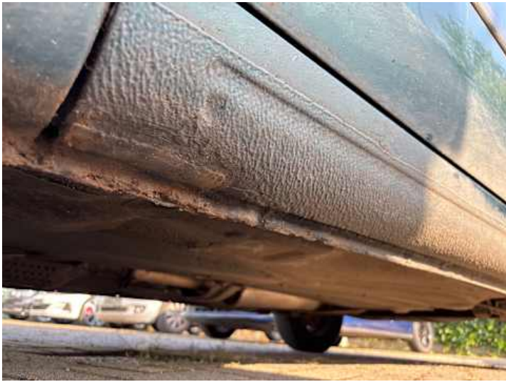
Schweller links (Rost, Kratzer, Lackschaden)
