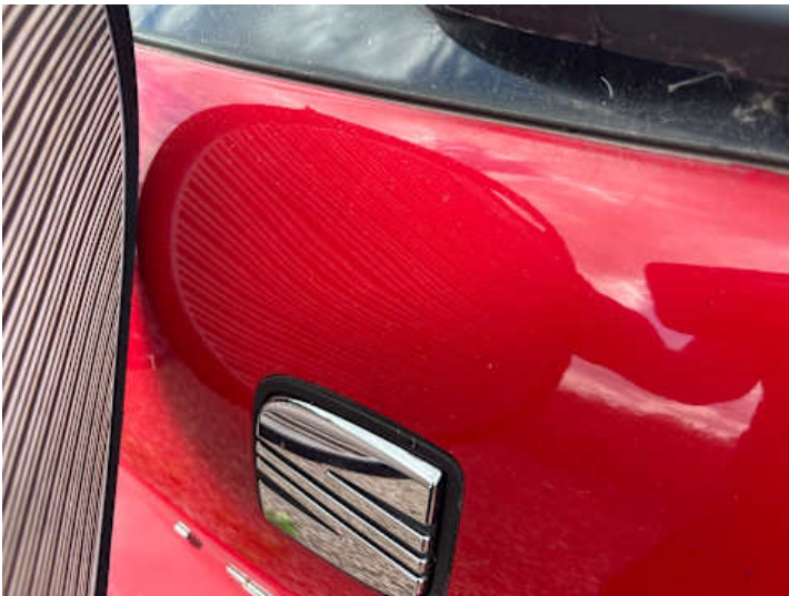
Heckklappe (Delle, Verformung)
