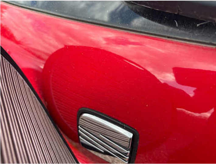
Heckklappe (Delle, Verformung)
