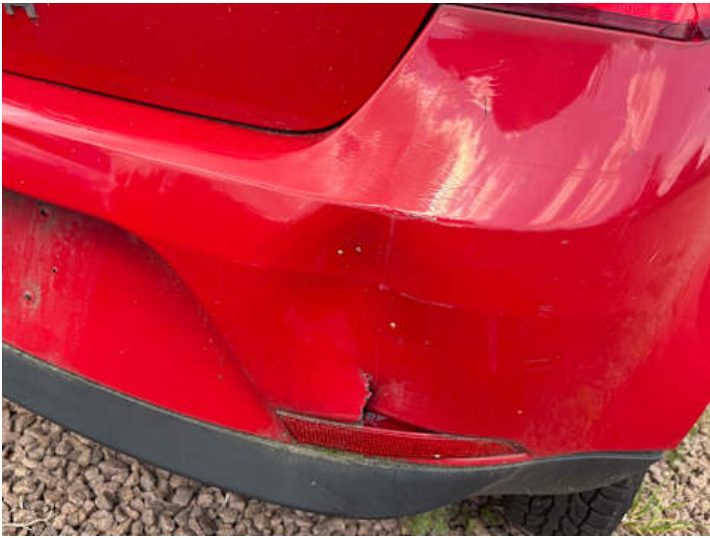
Stoßstange hinten (Kratzer, Lackschaden, Verformung, Spaltmaße ungenau)
