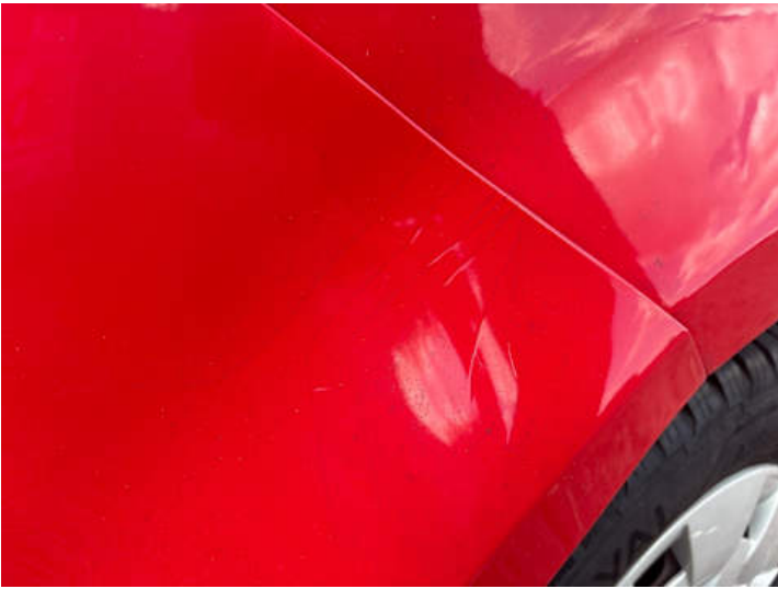
Stoßstange hinten (Kratzer, Lackschaden, Verformung, Spaltmaße ungenau)
