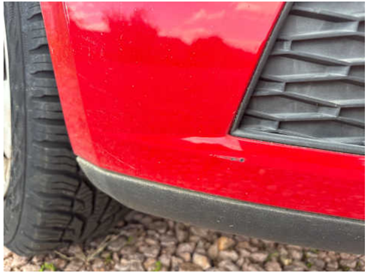
Stoßstange vorne (Kratzer, Lackschaden)
