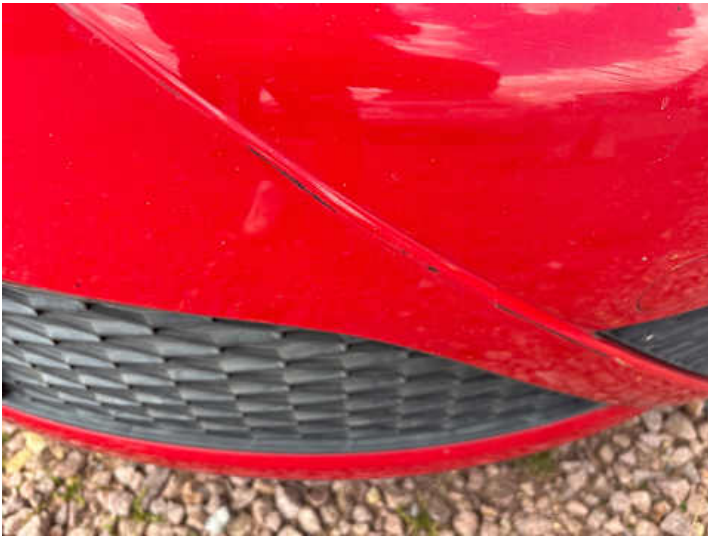
Stoßstange vorne (Kratzer, Lackschaden)
