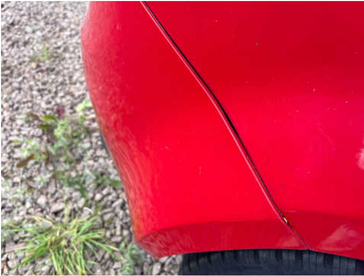
Stoßstange hinten (Kratzer, Lackschaden, Verformung, Spaltmaße ungenau)
