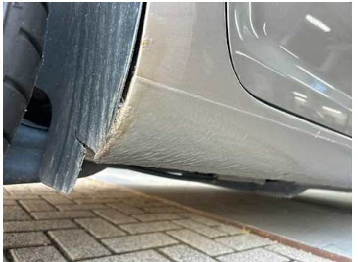
Schweller rechts (Rost)
