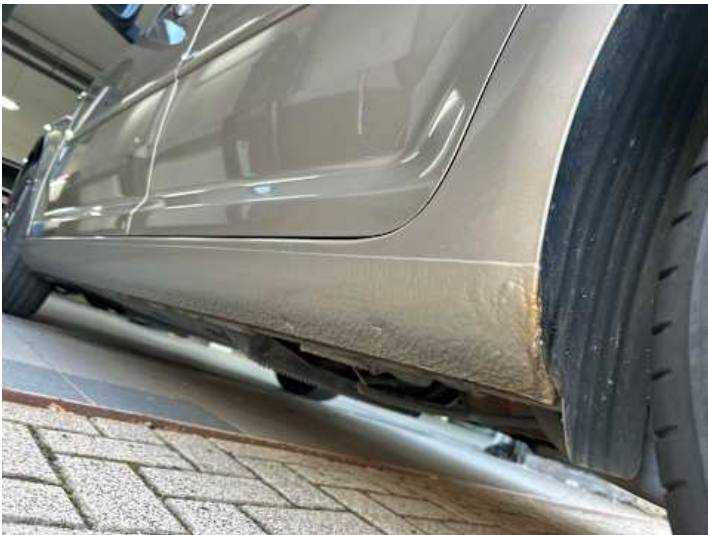
Schweller links (Rost)
