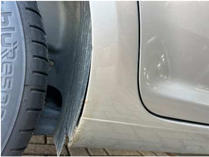
Seitenteil hinten rechts (Rost)
