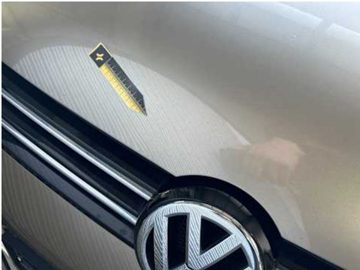
Motorhaube (Rost, Delle)
