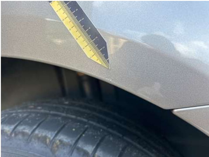
Seitenteil hinten links (Rost)
