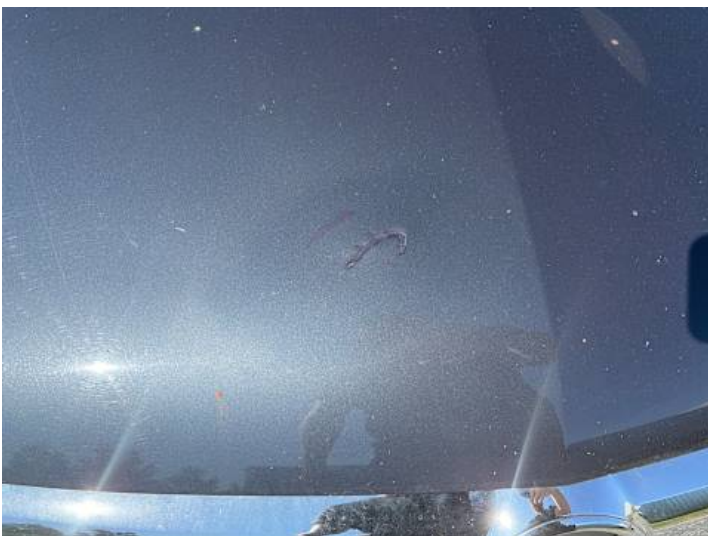
Motorhaube (Verformung, Lackschaden, Unsachgemäß instand gesetzt)
