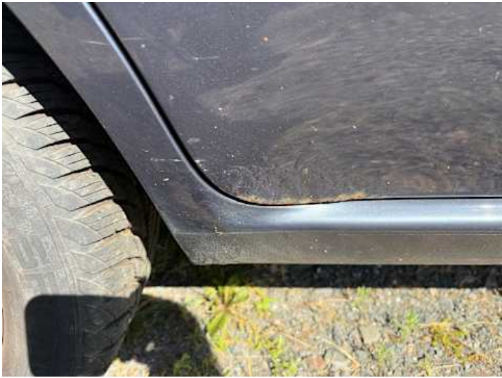
Türe hinten rechts (Rost, Lackschaden)
