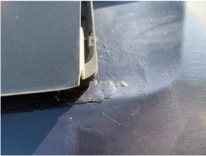
Heckklappe (Rost, Unsachgemäß instand gesetzt, Lackschaden)
