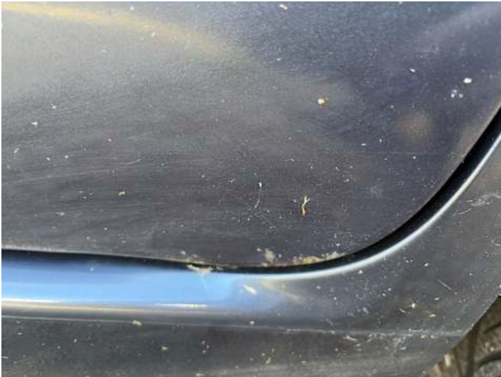
Türe hinten links (Rost, Lackschaden)
