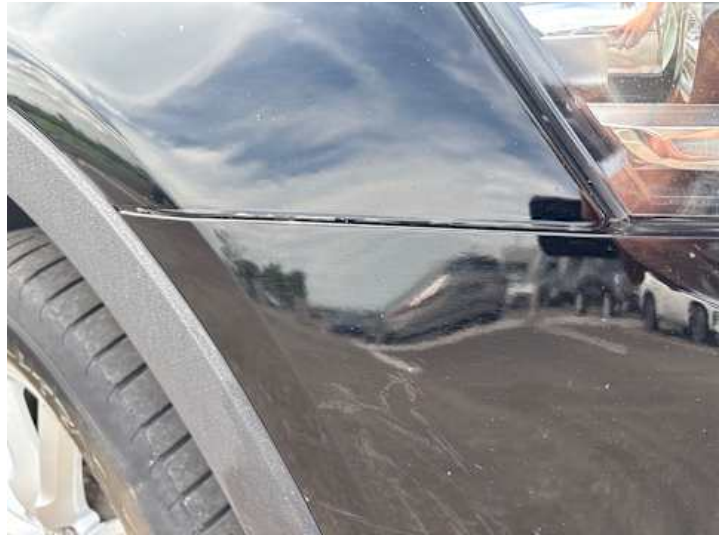
Kotflügel vorne rechts (Kratzer, Lackschaden, Unsachgemäß instand gesetzt)
