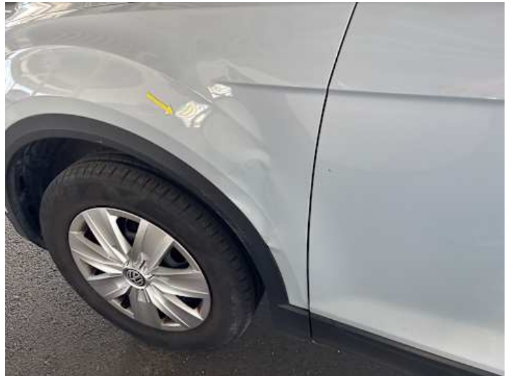
Kotflügel vorne links (Verformung, Kratzer)
