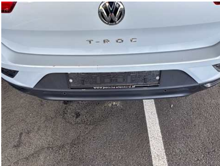
Stoßstange hinten (Kratzer)
