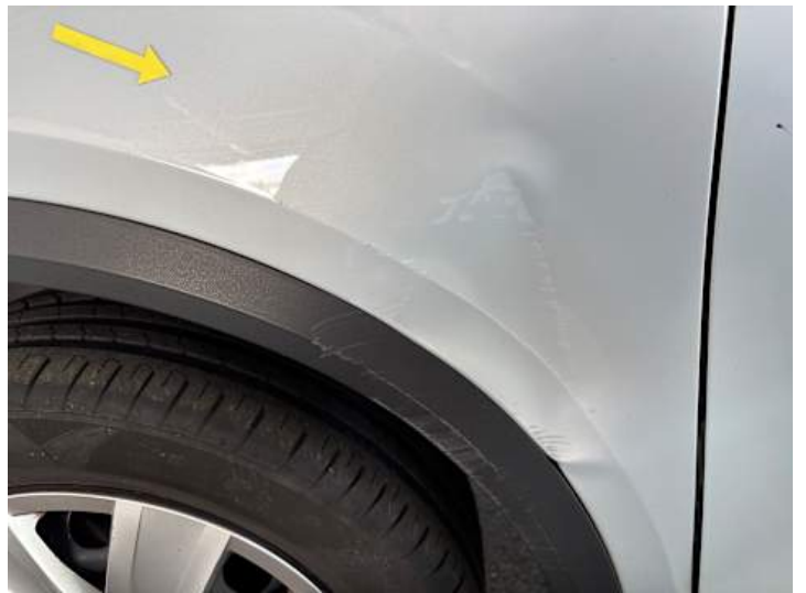
Kotflügel vorne links (Verformung, Kratzer)
