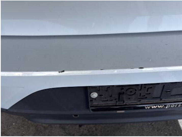
Stoßstange hinten (Kratzer)
