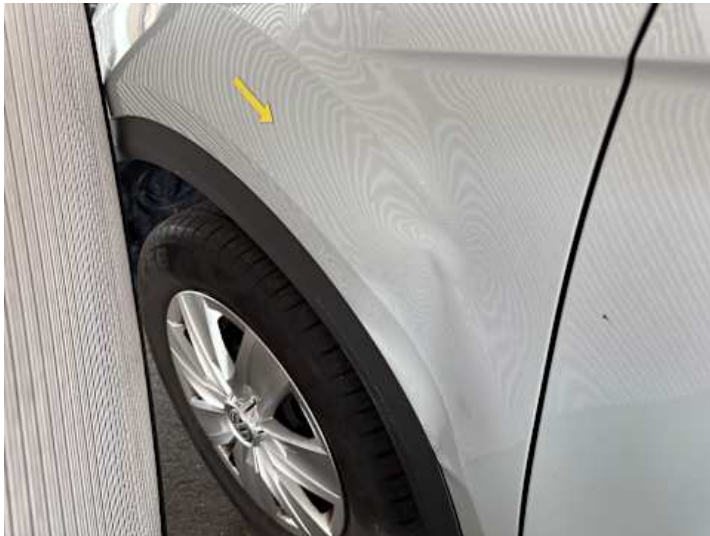
Kotflügel vorne links (Verformung, Kratzer)
