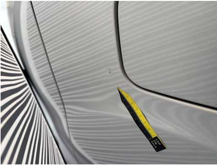
Seitenteil hinten links (Delle, Steinschlag)
