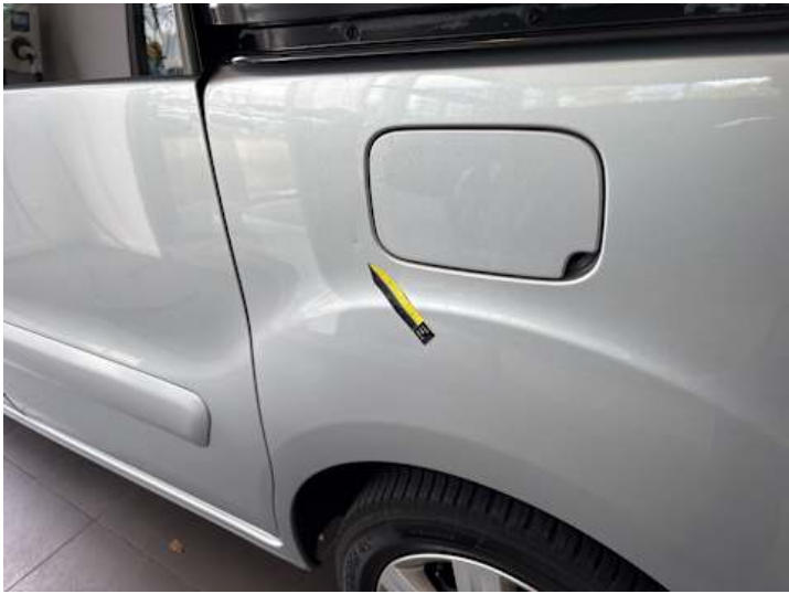
Seitenteil hinten links (Delle, Steinschlag)
