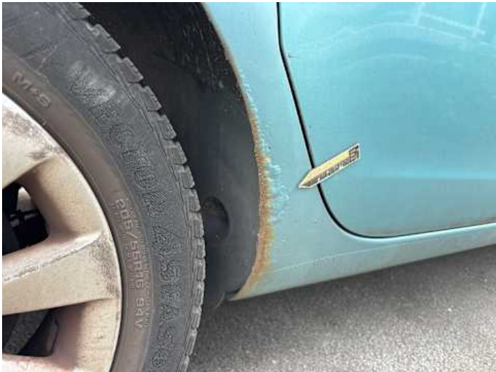
Seitenteil hinten rechts (Rost)
