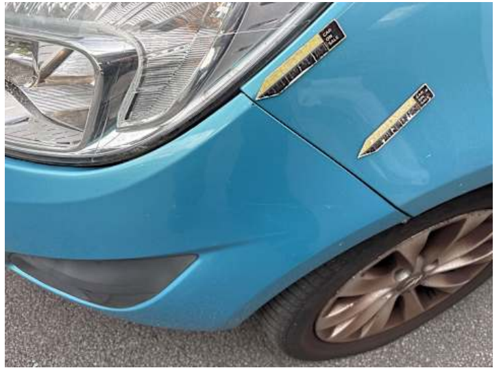
Stoßstange vorne (Kratzer, Spaltmaße ungenau)
