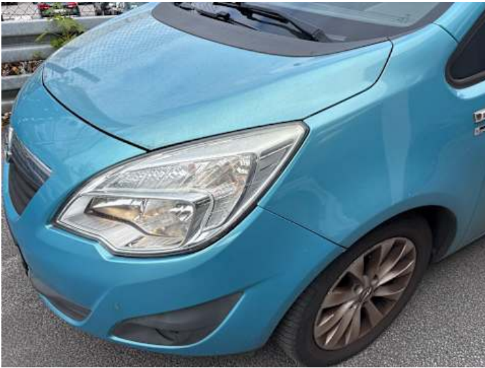
Stoßstange vorne (Anderer Schaden): Farbunterschied
