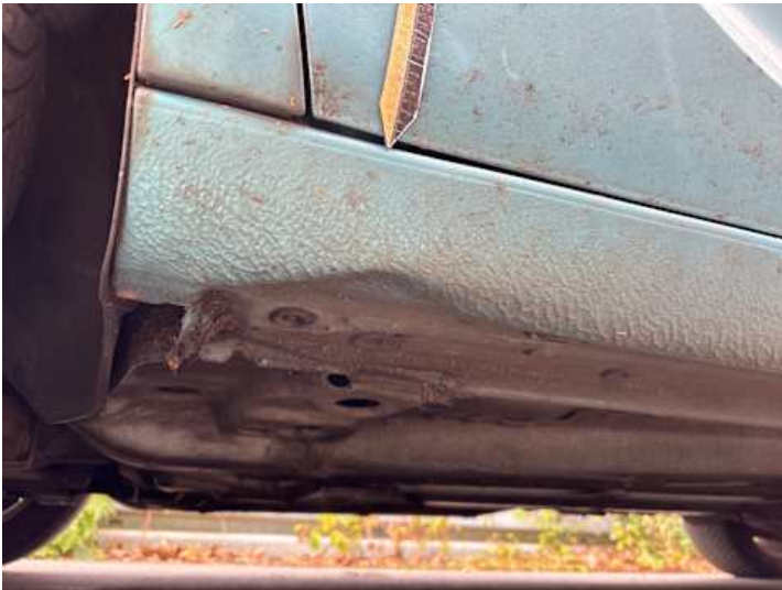
Schweller links (Verformung)
