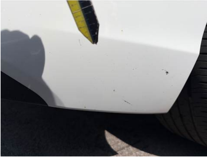
Stoßstange hinten (Lackschaden, Kratzer)
