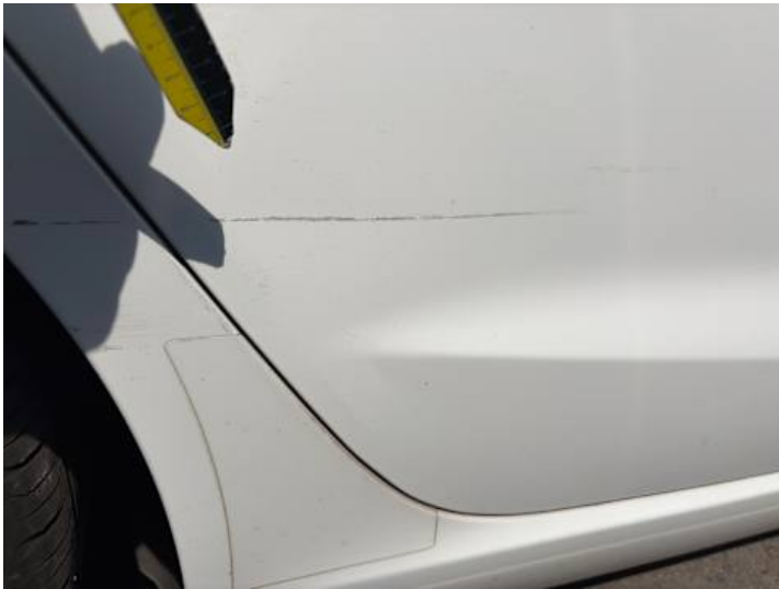
Türe hinten rechts (Lackschaden, Kratzer, Delle, Verformung)
