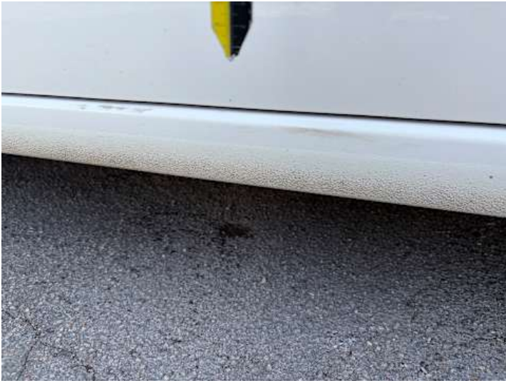
Schweller links (Lackschaden, Kratzer)
