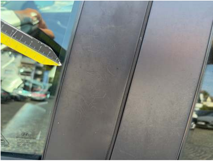
Fahrtür (Lackschaden, Kratzer)
