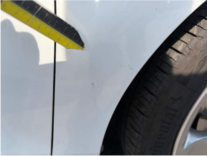
Kotflügel vorne rechts (Lackschaden, Kratzer)
