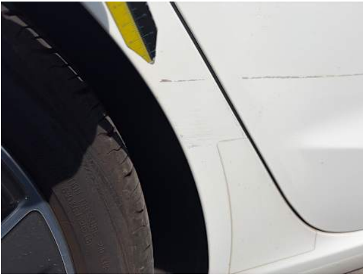
Seitenteil hinten rechts (Lackschaden, Kratzer)
