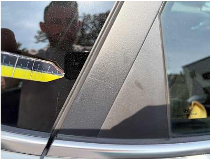
Türe hinten rechts (Lackschaden, Kratzer, Delle, Verformung)
