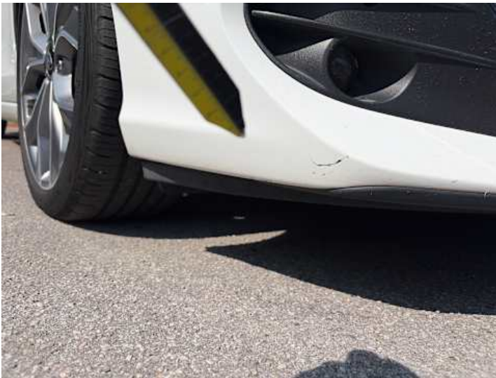
Stoßstange vorne (Lackschaden, Kratzer)
