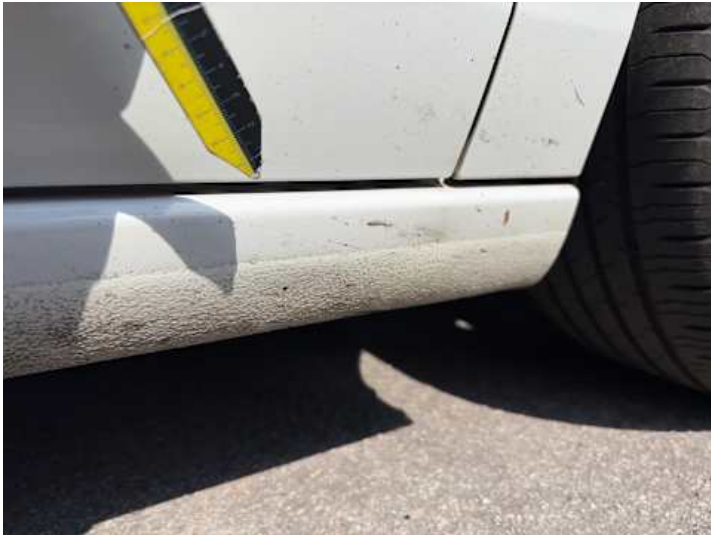
Schweller rechts (Delle, Lackschaden, Kratzer)
