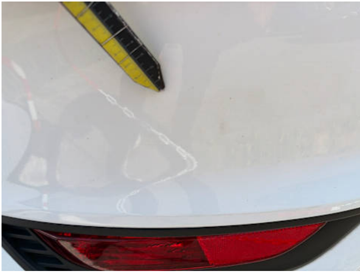
Stoßstange hinten (Lackschaden, Kratzer)
