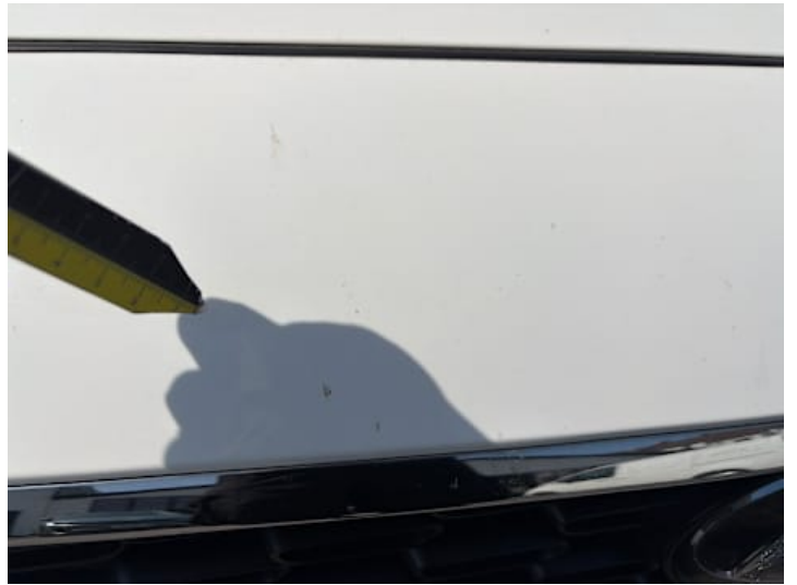
Stoßstange vorne (Lackschaden, Kratzer)
