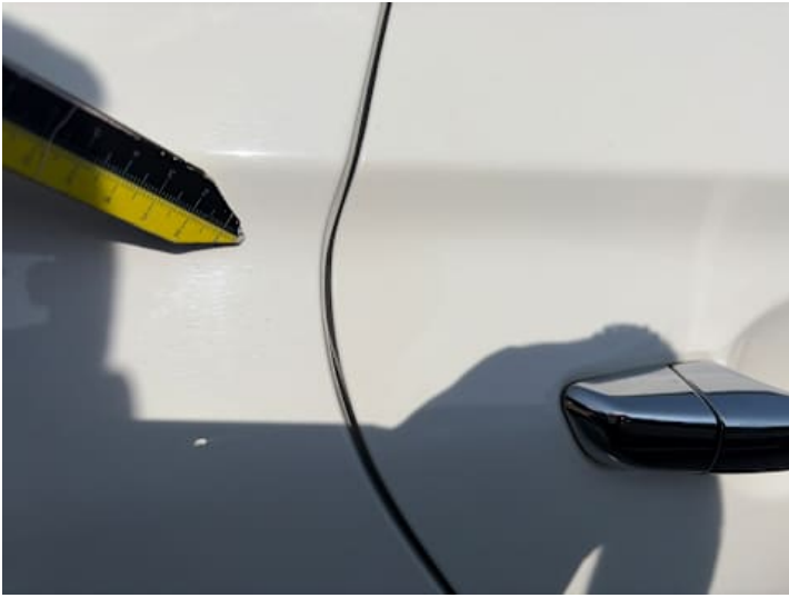
Türe hinten rechts (Lackschaden, Kratzer, Delle, Verformung)
