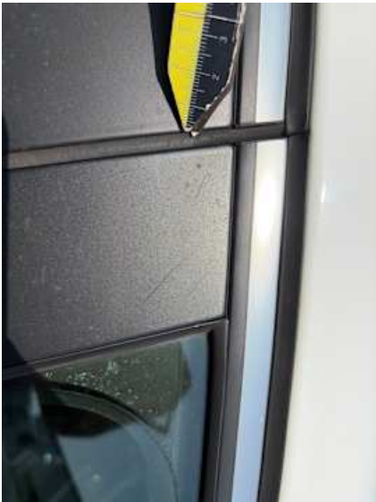
Beifahrertür (Lackschaden, Kratzer)
