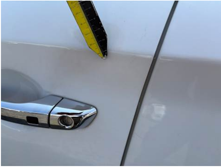
Fahrtür (Lackschaden, Kratzer)
