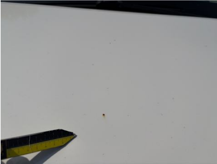
Motorhaube (Lackschaden, Kratzer, Steinschlag, Rost)
