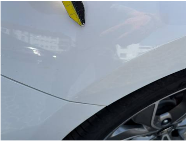
Kotflügel vorne links (Lackschaden, Kratzer)
