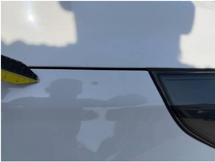
Kotflügel vorne rechts (Lackschaden, Kratzer)
