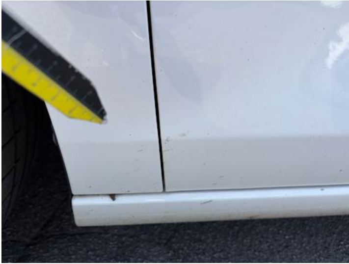
Fahrtür (Lackschaden, Kratzer)
