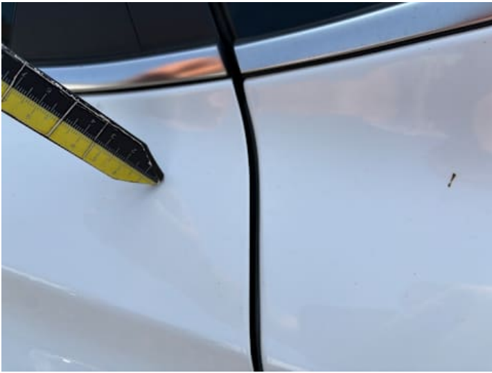
Türe hinten links (Lackschaden, Kratzer)
