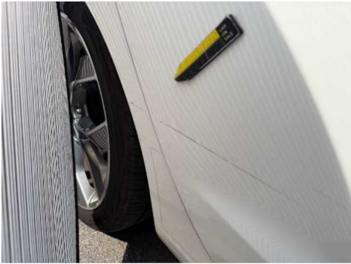
Seitenteil hinten rechts (Delle, Verformung)
