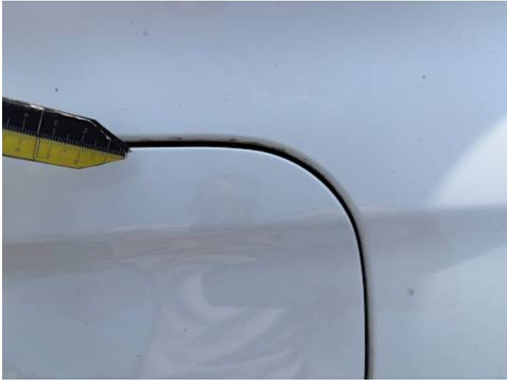
Seitenteil hinten links (Lackschaden, Kratzer)
