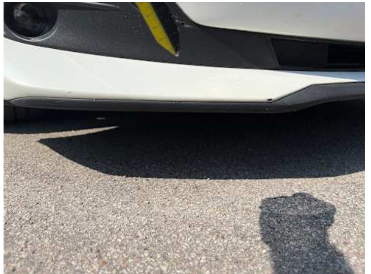
Stoßstange vorne (Lackschaden, Kratzer)
