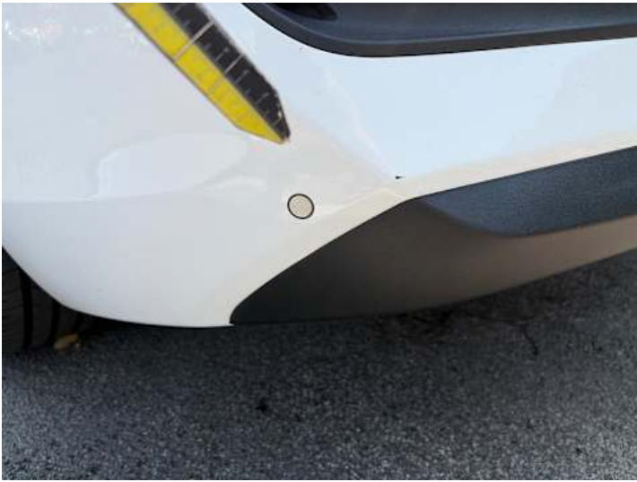
Stoßstange hinten (Lackschaden, Kratzer)
