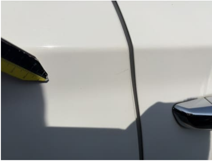
Türe hinten rechts (Lackschaden, Kratzer, Delle, Verformung)
