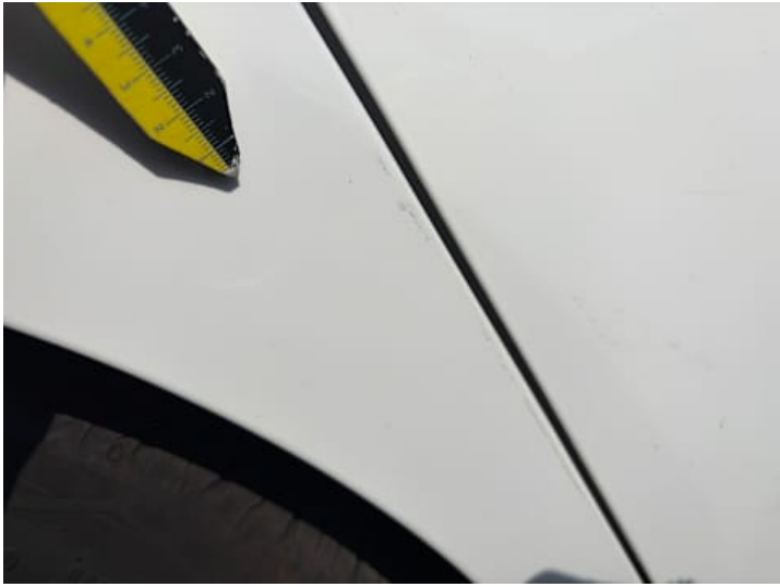
Seitenteil hinten rechts (Lackschaden, Kratzer)
