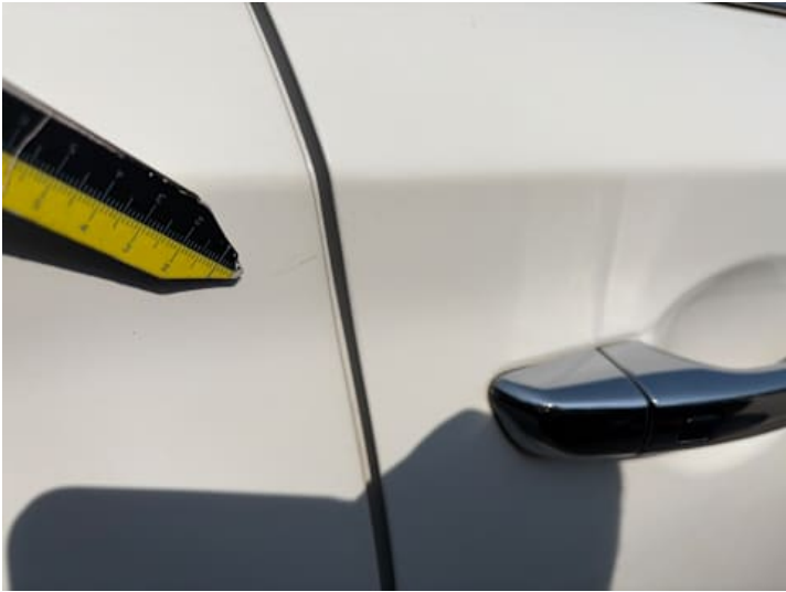
Beifahrertür (Lackschaden, Kratzer)
