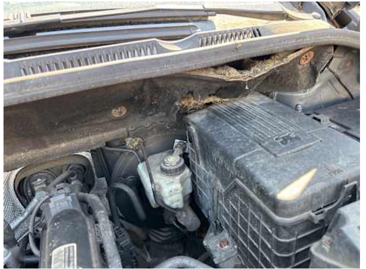
Motorhaube (Anderer Schaden): Dämmung
