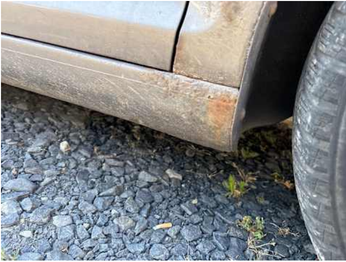
Schweller rechts (Rost)
