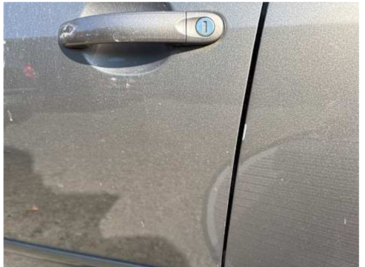
Türe hinten links (Lackschaden)
