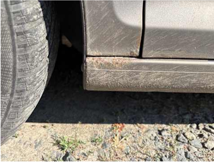
Schweller links (Rost)
